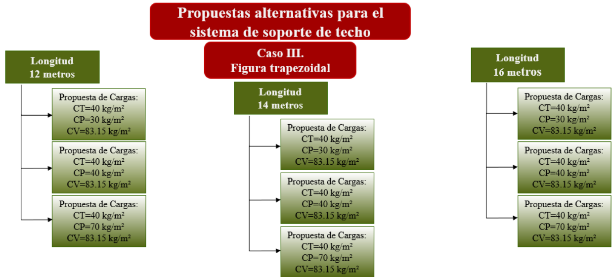
Fig. 17 Diagrama de flujo para la obtención de las propuestas alternativas del caso 3.
