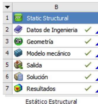
Ilustración 41. Células de análisis estructural del banco de trabajo de ANSYS.
