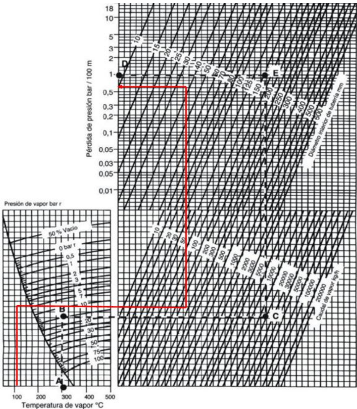
Ilustración 7. Caída de presión en tubería
