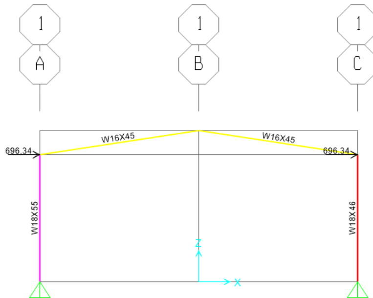
Figura 11. Fuerzas sísmicas. Fuente propia.
