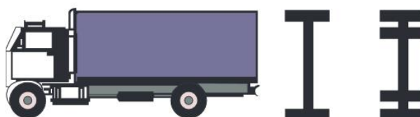
Ilustración 8 Distribución de vehículo con doble eje Fuente: (Ulloa, Allen, Badilla, & Sibaja, 2007)
