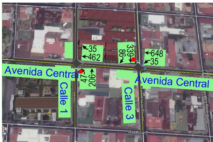
Ilustración 32 Vista en planta de la evaluación 1
