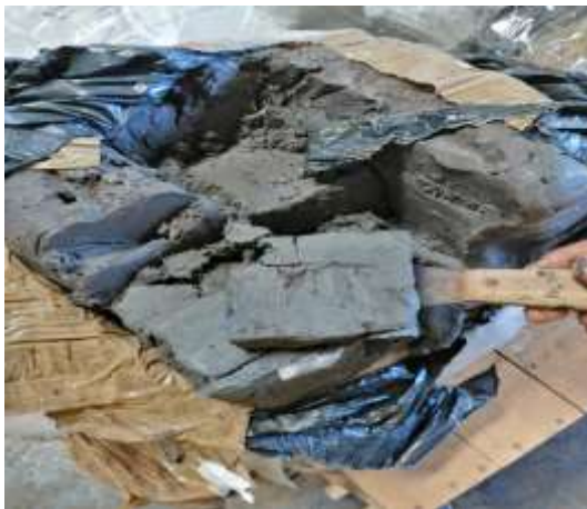
Figura 31. Extracción de cubo de muestra inalterada
