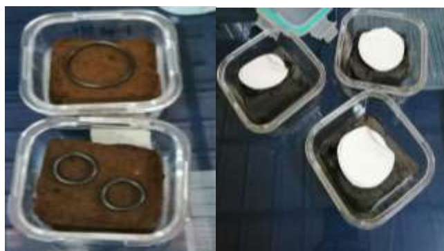
Figura 33. Colocación de O-rings y papel filtro
