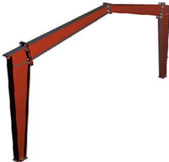
Figura 6. Marco rígido interno
