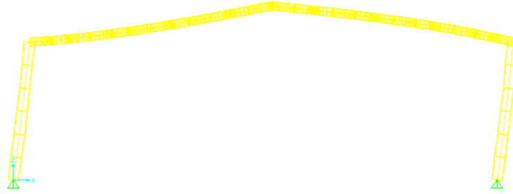
Figura 45. Desplazamiento Marco OMF debido a las Fuerzas Sísmicas en el Eje (x)
