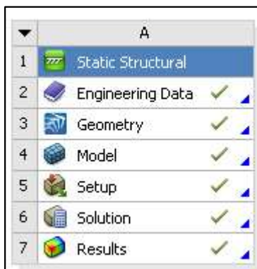
Figura 12. Célula de análisis estructural estático de ANSYS Workbench. Fuente: ANSYS Workbench, modificado por autora.
