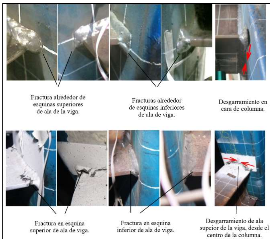
Figura 42. Fenómeno de falla en conexiones soldadas bajo cargas cíclicas. Fuente: Song, Heidarpour, Zhao, & Han, 2015, modificado por autora.
