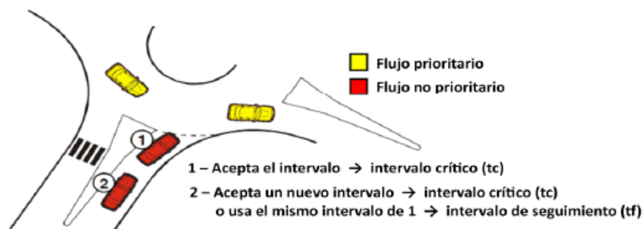
Ilustración 6. Funcionamiento de una rotonda
