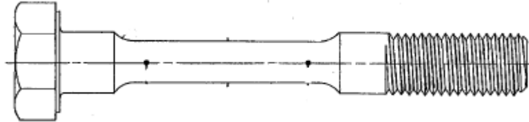
Ilustración 37. Visualización de la elongación de un perno después de la fractura. Cuya deformación equivale a 2 Fuente: SAE J-429 Requerimientos mecanicos.
