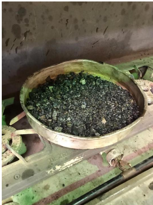
Ilustración 2. Agregado extraído de la mezcla asfáltica.
