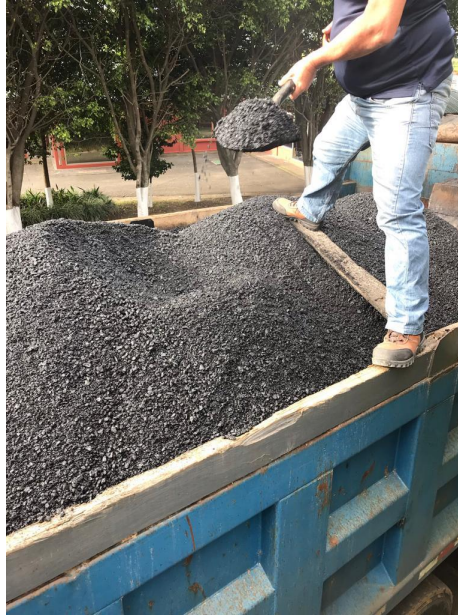
Ilustración 24. Recolección de muestra asfáltica.
