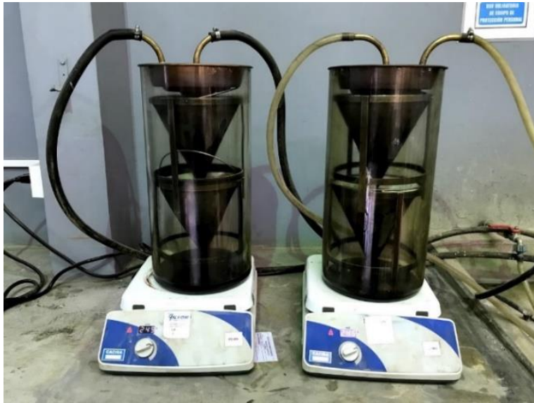
Ilustración 11. Extracción del ligante asfáltico.
