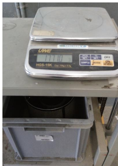
Figura 94. Determinación del peso sumergido de los especímenes cilíndricos
