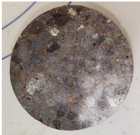
Figura 92. Pulido de las caras externas del cilindro de 100mm x 200mm de altura 7 días después de su elaboración
