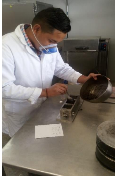
Figura 76. Proceso de elaboración de concreto polimérico utilizando el método alternativo
