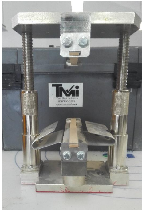
Figura 53. Marco robusto para ensayo a tracción indirecta de cilindros, norma ASTM C496
