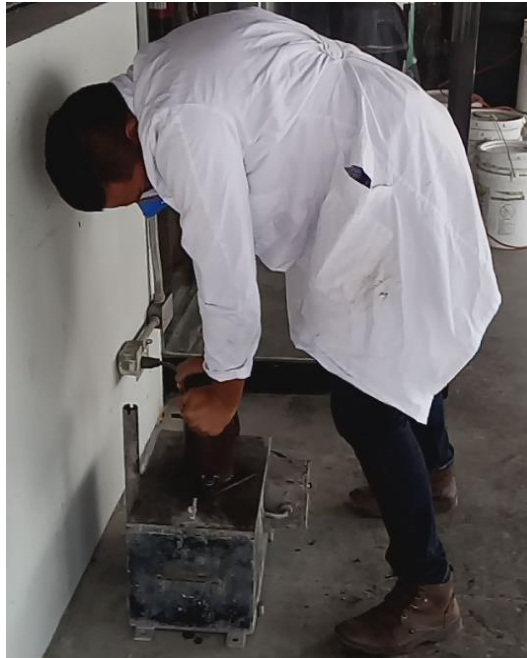
Figura 89. Proceso de vibrado de cilindros del concreto polimérico
