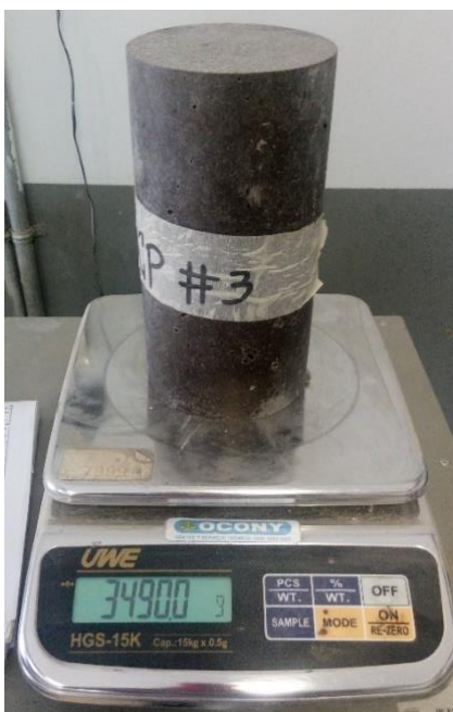
Figura 96. Masa saturada superficie seca de cilindro #3 posterior del sumergido
