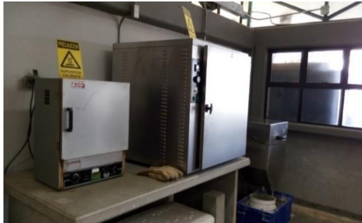
Figura 64. Secado de agregados al horno durante un día
