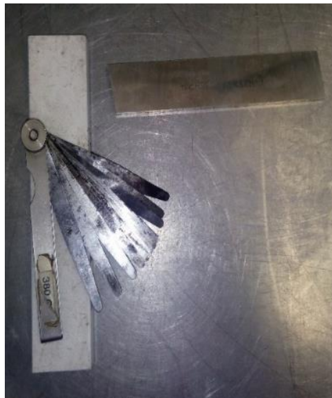
Figura 54. Equipo para determinar planicidad de las caras extremas: regla de acero calibrada, juego de galgas calibrada
