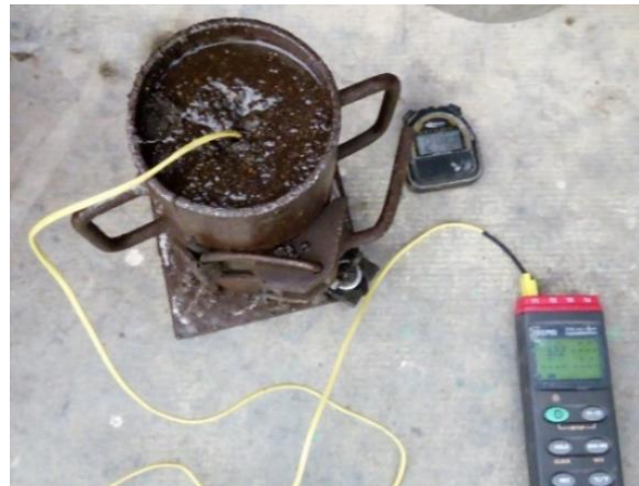
Figura 123. Proceso de determinación de calorimetría del concreto polimérico
