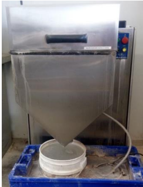
Figura 55. Máquina pulidora de caras extremas de cilindros/ Marca DIAM end Grinder
