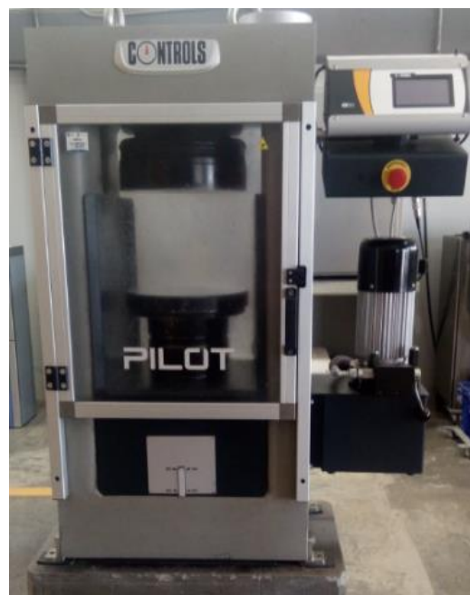
Figura 48. Prensa hidráulica automática de ensayo a compresión/ Marca CONTROLS/ Modelo PILOT/ Fecha de calibración: (07/03/17)
