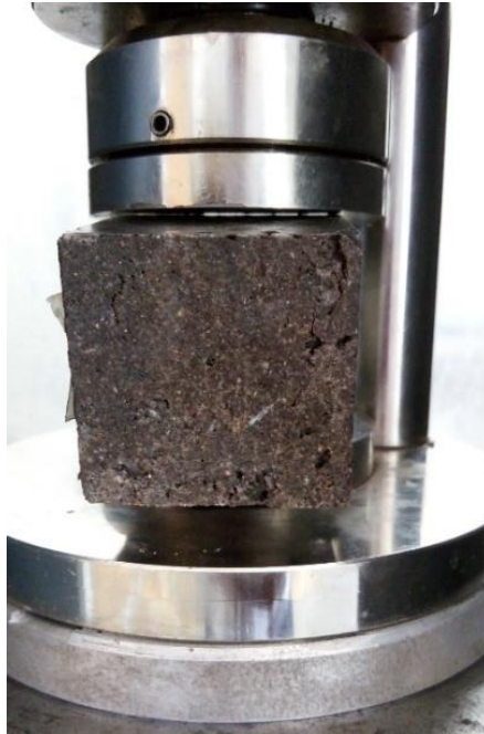
Figura 84. Falla a compresión de prueba #15 de concreto polimérico
