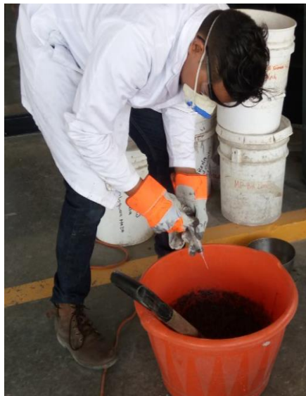
Figura 106. Adición de catalizador en la mezcla de concreto polimérico
