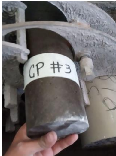
Figura 97. Proceso de pulido de las caras externas del cilindro #3
