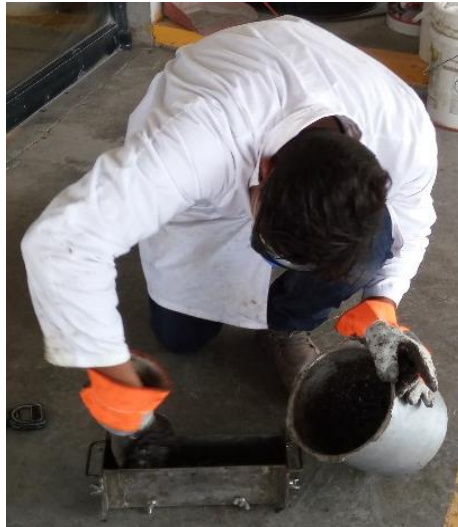
Figura 118. Elaboración de vigas de concreto polimérico
