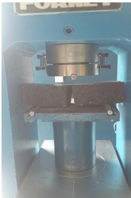
Figura 121. Falla de viga de concreto polimérico con carga en el punto medio
