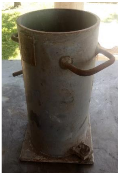
Figura 63. Molde para elaboración de cilindros de diámetro 150 x 300mm de altura y de diámetro 200 x 100mm de altura
