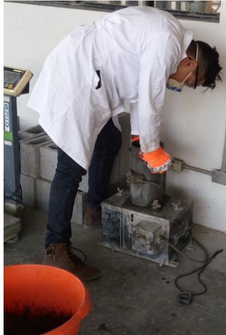
Figura 107. Proceso de vibrado de la mezcla
