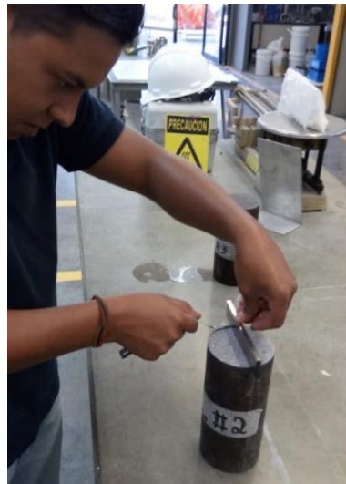
Figura 98. Determinación de la planicidad de las caras exteriores del cilindro
