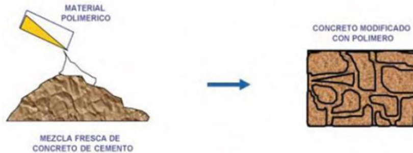
Figura 8. Modificación del concreto hidráulico mediante la adición de una resina o polímero
