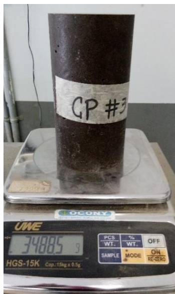
Figura 93. Determinación del peso seco de los cilindros de concreto
