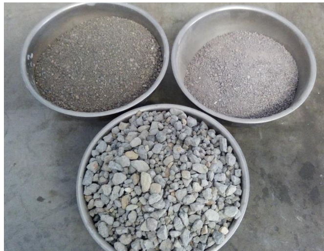
Figura 101. Pesado de los agregados de la mezcla de concreto polimérico
