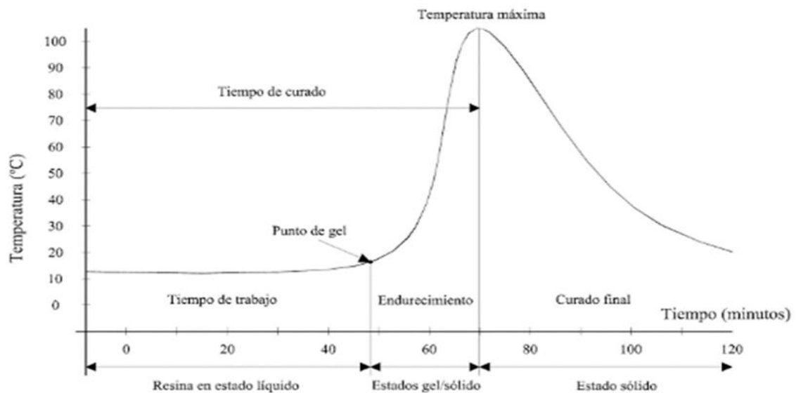
Figura 6. Curva exotérmica característica de una resina
