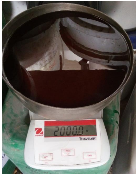
Figura 102. Dosificación de dos litros de resina de poliéster
