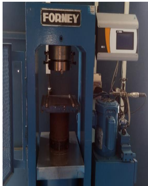
Figura 56. Máquina hidráulica para compresión de vigas, marca FORNEY, fecha de calibración: (07/03/17)
