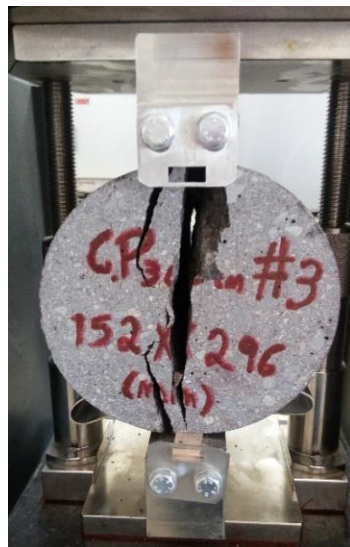
Figura 112. Falla a tracción indirecta de cilindro #3
