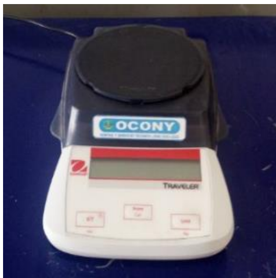
Figura 51. Balanza de precisión/ Marca OHAUS-Traveler/ Modelo: TA 5000, cap. 5kg/ Fecha de calibración: (14/12/15)
