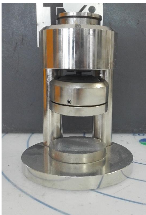
Figura 52. Marco robusto para falla a compresión de cemento y mortero
