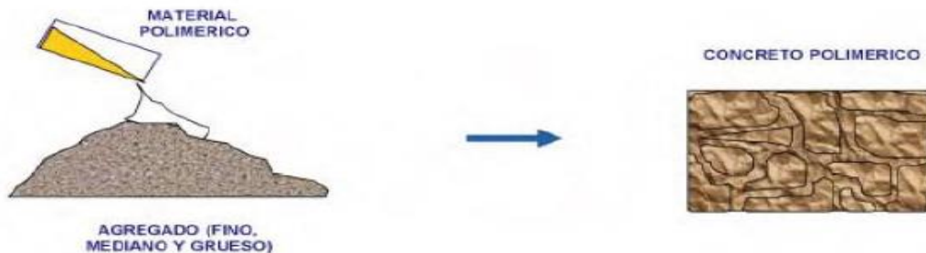
Figura 9. Esquema de elaboración del concreto polimérico
