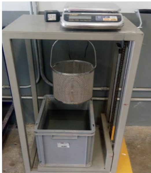
Figura 50. Balanza cap. 15 kg/ Modelo UWE HGS 15K para determinar densidad de un sólido/ Fecha de calibración: (14/12/15)
