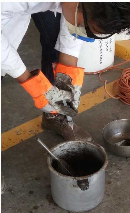
Figura 88. Adición de catalizador a la mezcla de concreto polimérico
