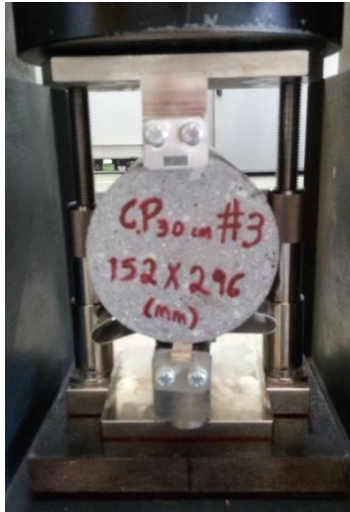
Figura 111. Modelo de colocación de cilindro #3
