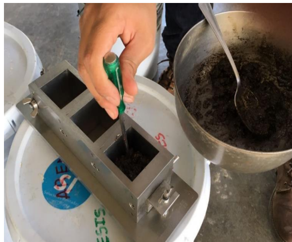
Figura 77. Consolidación de mezcla de concreto polimérico, utilizando punzón
