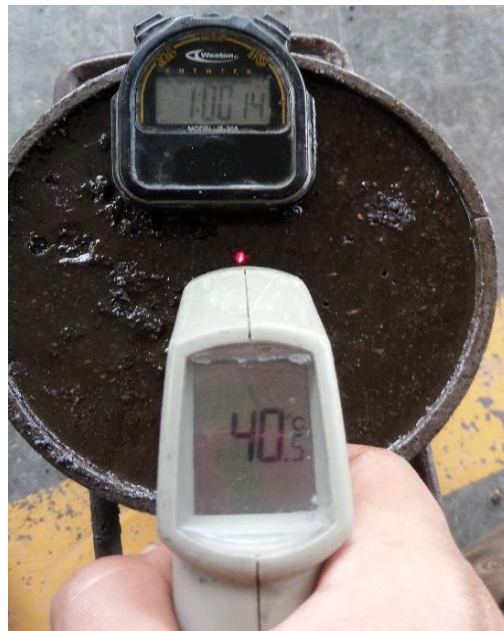
Figura 90. Toma de la temperatura superficial del concreto a una hora
