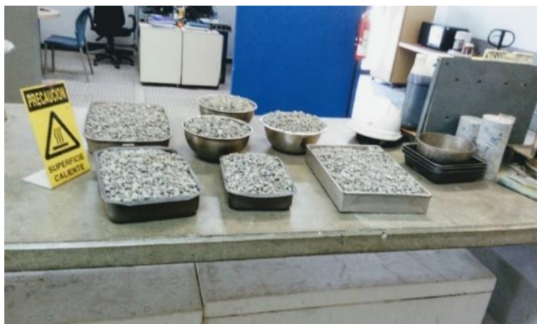
Figura 65. Enfriado de agregados a temperatura ambiente
