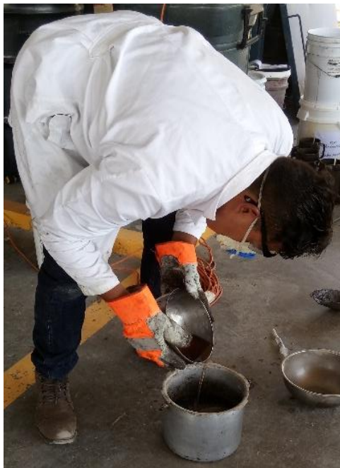
Figura 117. Incorporación de la resina de poliéster a la mezcla de agregados
