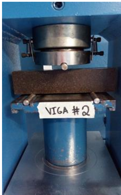
Figura 120. Modelo de falla a flexión de viga #2 con carga en el centro del claro, distancia entre apoyos= 17.7cm.
