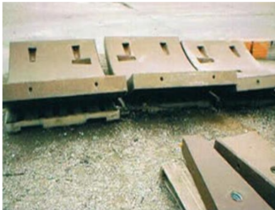
Figura 29. Revestimiento de túneles de concreto polimérico
