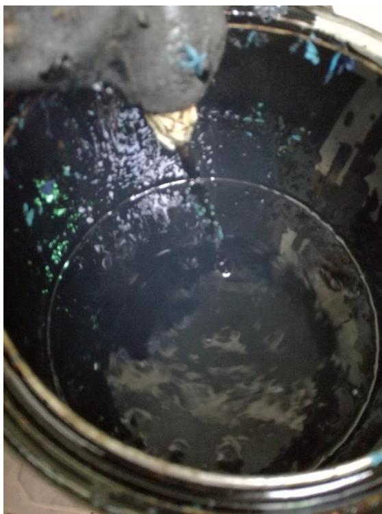
4. Cemento asfáltico con plástico incluido
