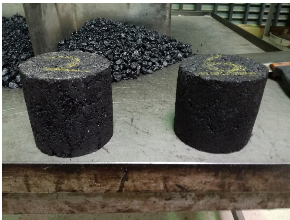
6. Especímenes para el ensayo de resistencia retenida a la compresión uniaxial.
