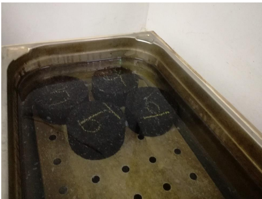
8. Baño de agua para mantener las pastillas saturadas a 60 °C
