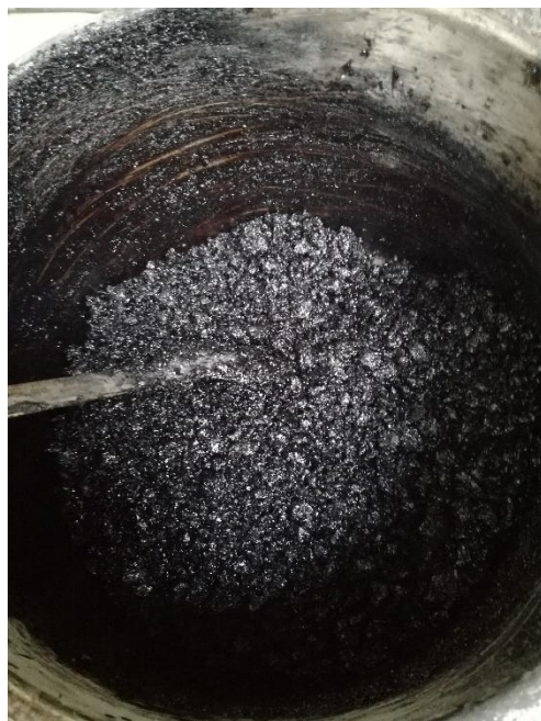
5. Mezcla asfáltica con plástico incluido
