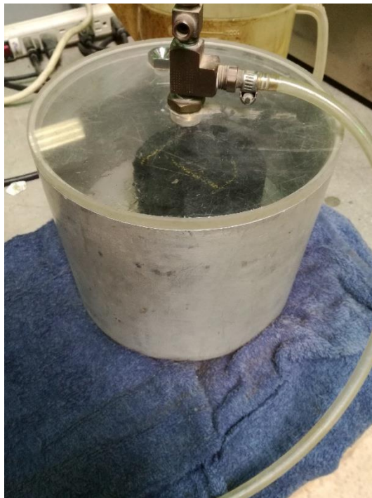
7. Bomba de vacío para saturar las pastillas de tensión diametral.
