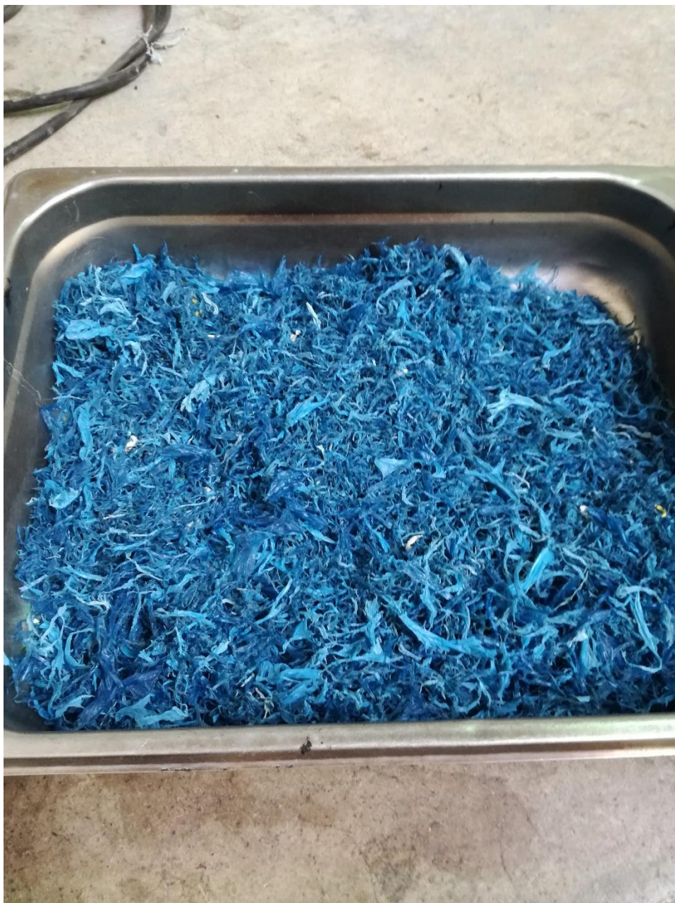
13. Plástico tipo PE de baja densidad, reciclado de la industria bananera.
