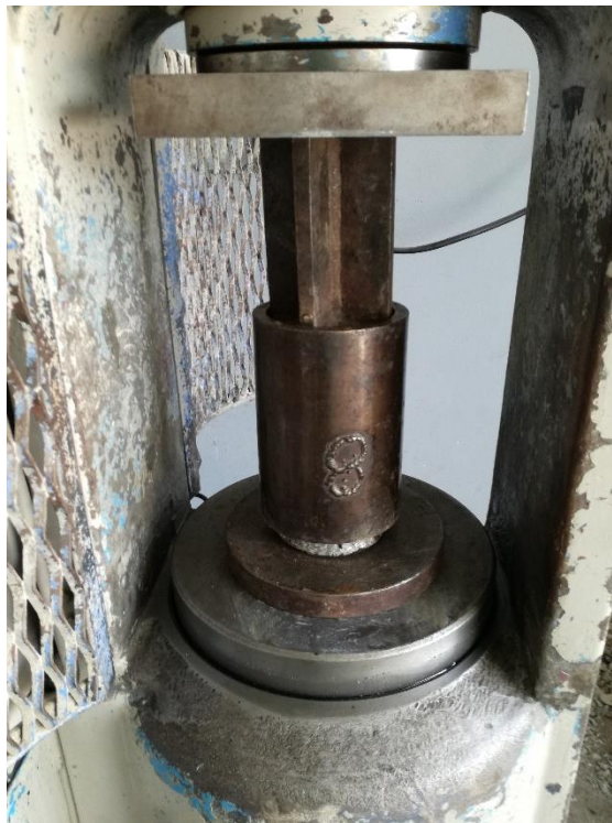
10. Prensa hidráulica, para moldear los especímenes de resistencia retenida.
