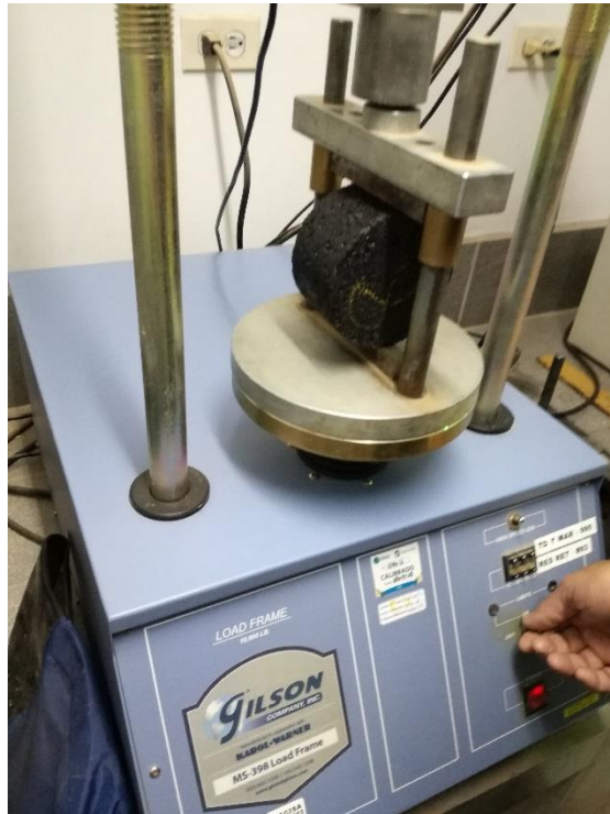
9. Prensa hidráulica para fallar a tensión diametral.
