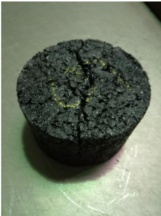
3. Espécimen de diseño Marshall fallado
