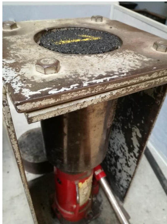
12. Gato hidráulico para extraer los especímenes de los moldes.
