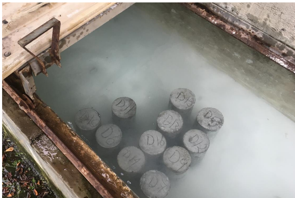
Ilustración 30 Pilas de cura
