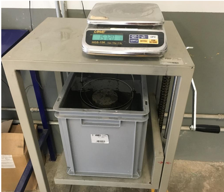
Ilustración 15 Balanza para pesado de especímenes sumergidos
