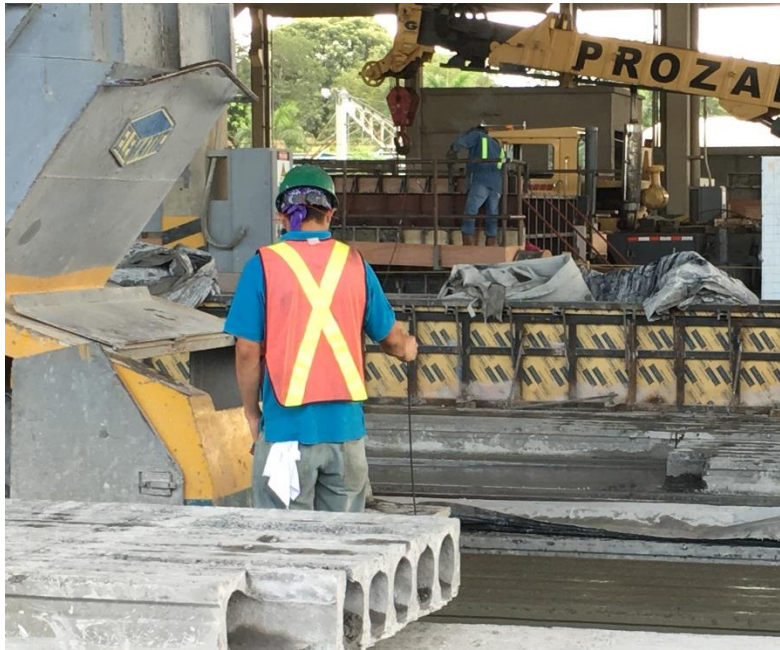
Ilustración 11 Verificación de espesor
