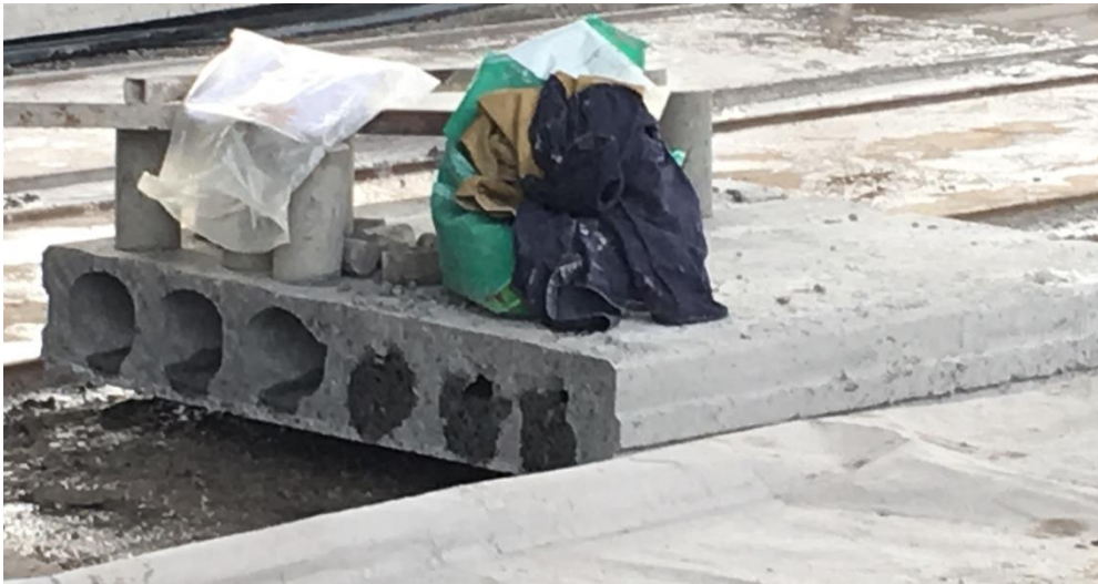
Ilustración 34 Corte transversal de la losa de prueba
