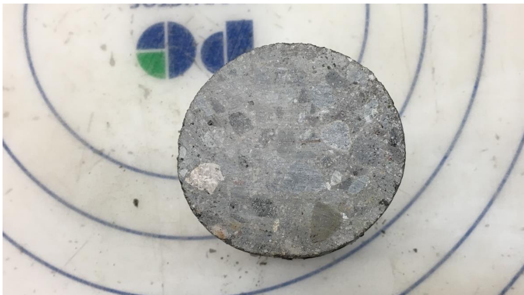
Ilustración 46 Deformidad en especímenes debido a problemas por moldes
