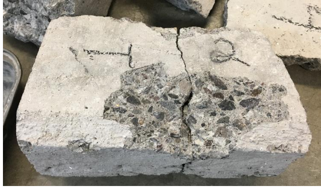
Ilustración 36 Piezas 1 y 2 de losa para cálculo de densidad seca
