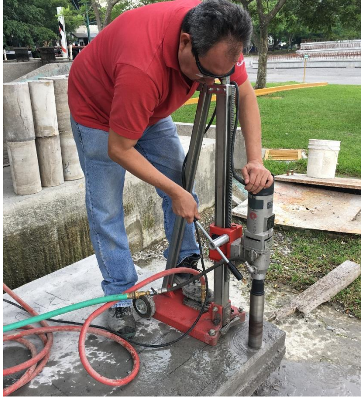
Ilustración 18 Equipo para extraer núcleos
