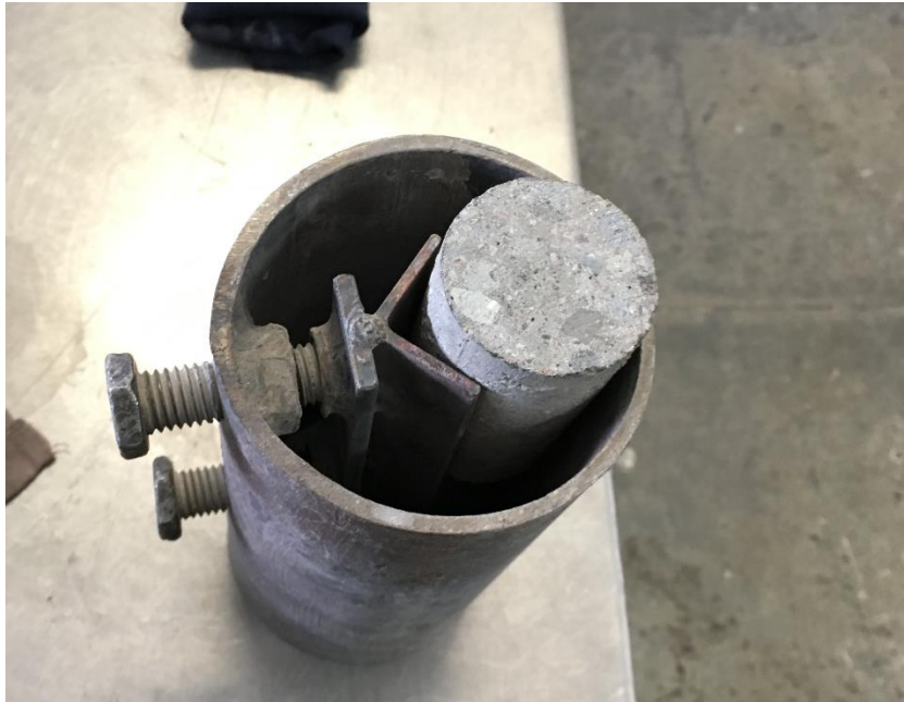
Ilustración 26 Adaptador para pulir especímenes de 5cm de diámetro
