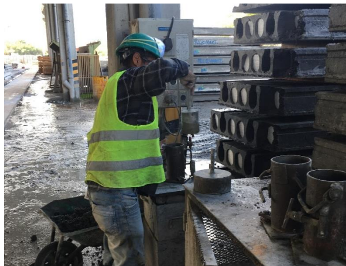
Ilustración 10 Proceso de realización de cilindros de concreto
