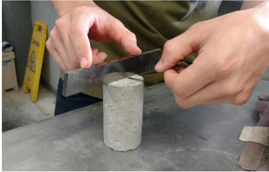
Ilustración 27 Revisión de la planicidad de los especímenes
