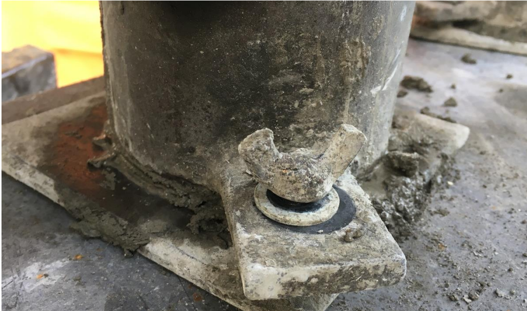
Ilustración 45 Moldes con tuercas sueltas
