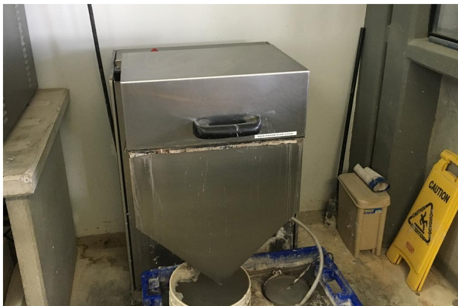
Ilustración 25 Máquina pulidora para cilindros de concreto
