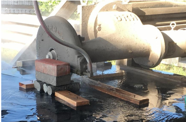
Ilustración 19 Proceso de corte de núcleos
