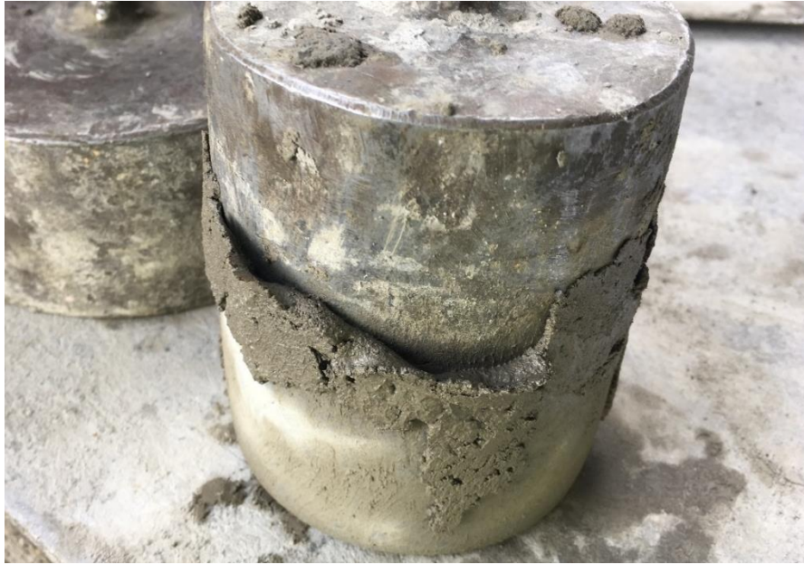
Ilustración 47 Pasta de la mezcla emergiendo por excesivo vibrado
