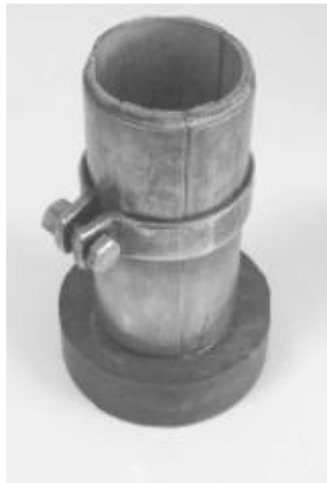
Ilustración 20 Cilindro para método de Frasson Jr.
