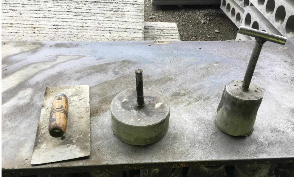
Ilustración 16 Llaneta, sobrecarga grande y sobrecarga pequeña
