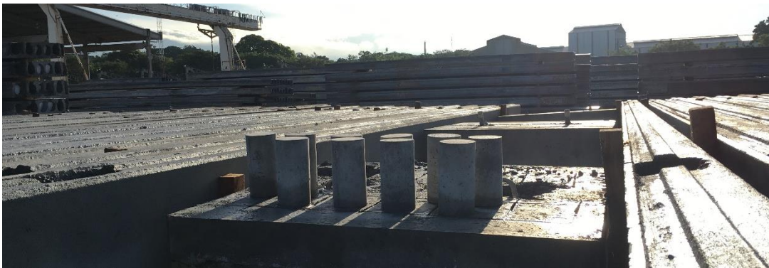
Ilustración 32 Cilindros con cura en patio
