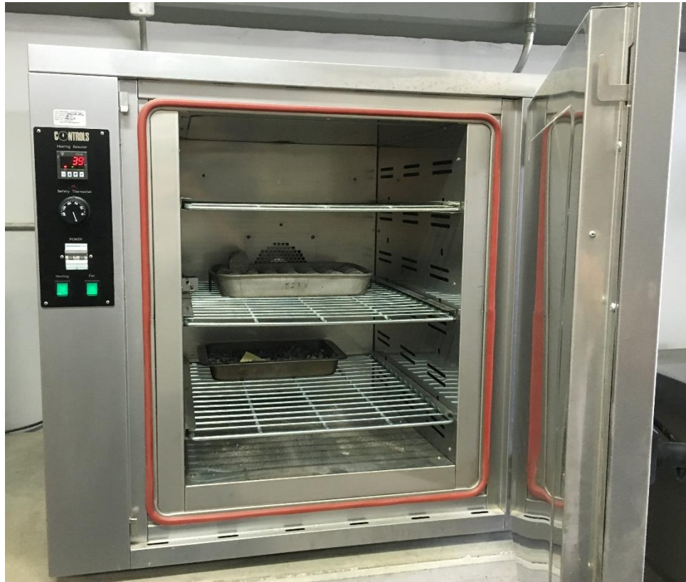
Ilustración 14 Horno para secado
