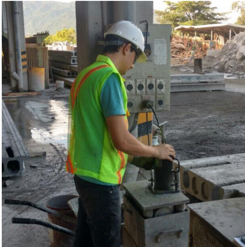
Ilustración 28 Elaboración de especímenes variando el tiempo de vibrado
