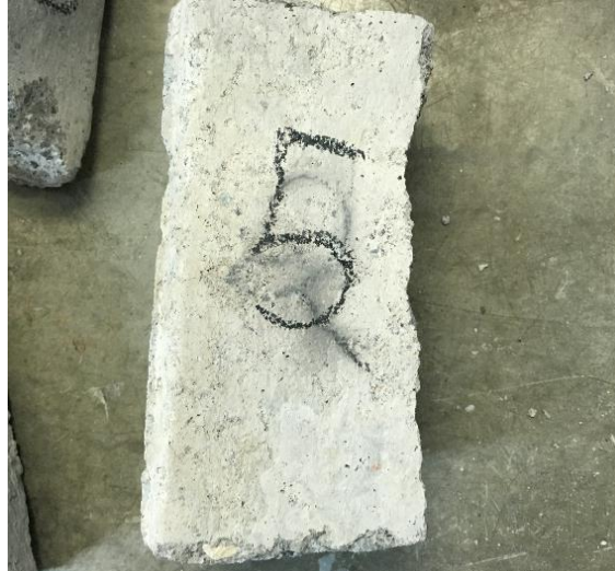
Ilustración 38 Pieza 5 de losa para cálculo de densidad seca
