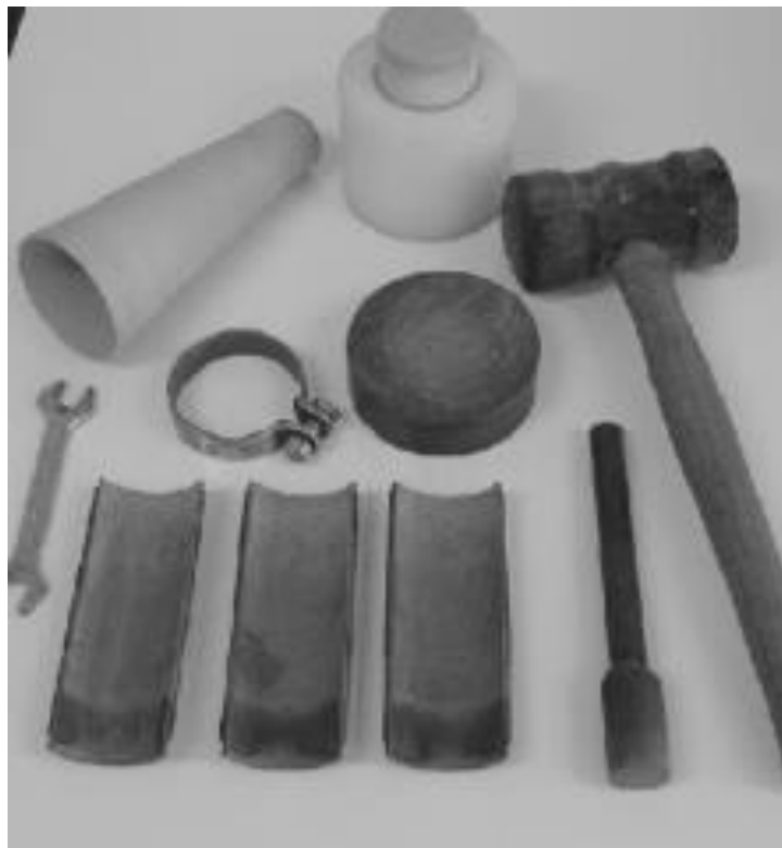
Ilustración 21 Set para método de Frasson Jr.
