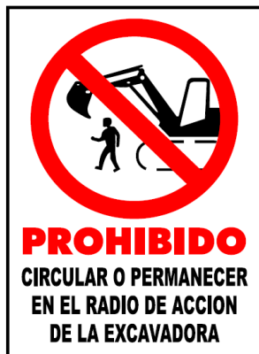
Figura 18. Prohibido circular o permanecer en el radio de acción de la excavadora.
