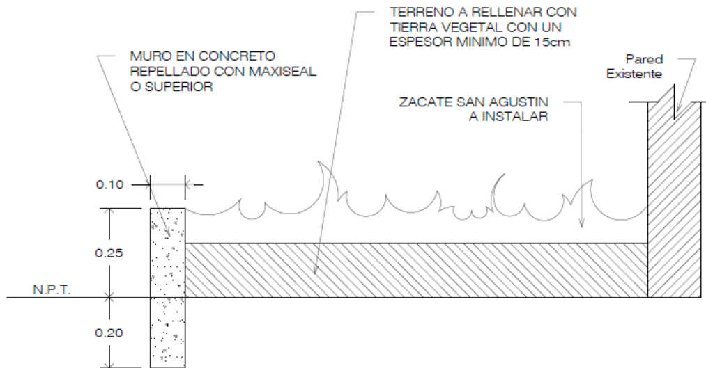
Figura 37. Detalle bordillo zona verde.
