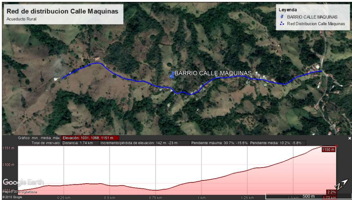
Ilustración 16 Perfil longitudinal red de conducción Calle Máquinas. Fuente propia. Imagen descargada de Google Earth .
