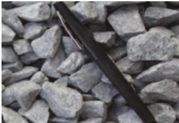
Ilustración 15 Apariencia Piedra ASTM N°57 para base de Sistema de pavimento permeable
