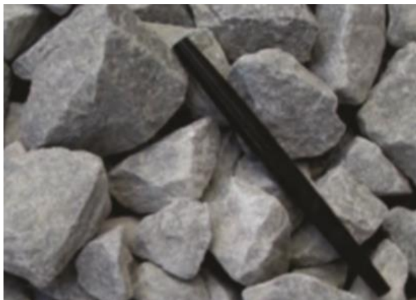
Ilustración 16 Apariencia Piedra ASTM N°2 para subbase de Sistema de pavimento
