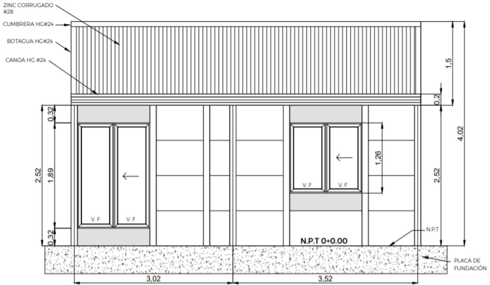
Figura 23 Elevación Frontal Sistema Prefabricado – Cubierta de 2 aguas
