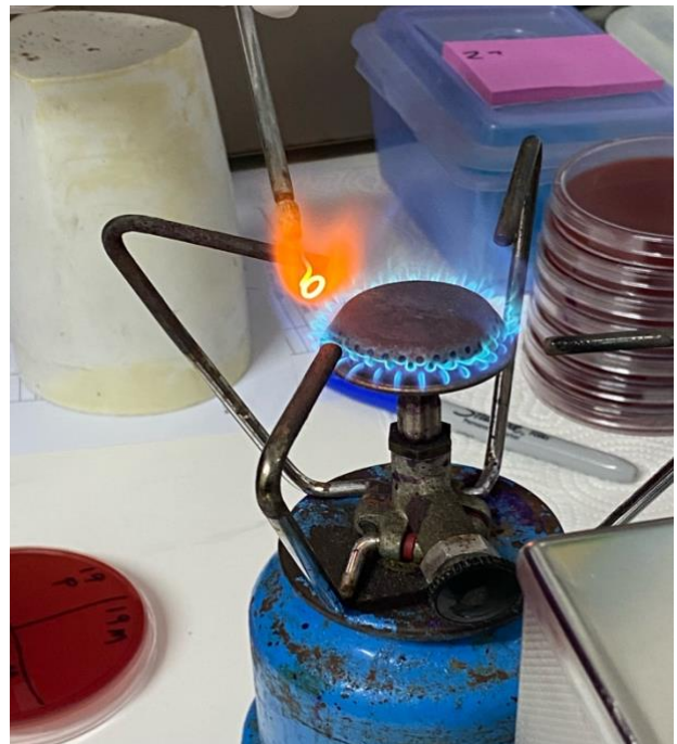
Esterilización de asa bacteriológica con calor emitido por el mechero de Bunsen.
