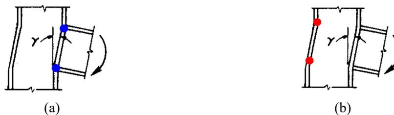
En las figuras anteriores se muestra una manera muy común de obtener la rotación para este caso se extraerán de dos maneras distintas, la primera punto 1 en la figura (a) y punto 2 en la figura (b).
