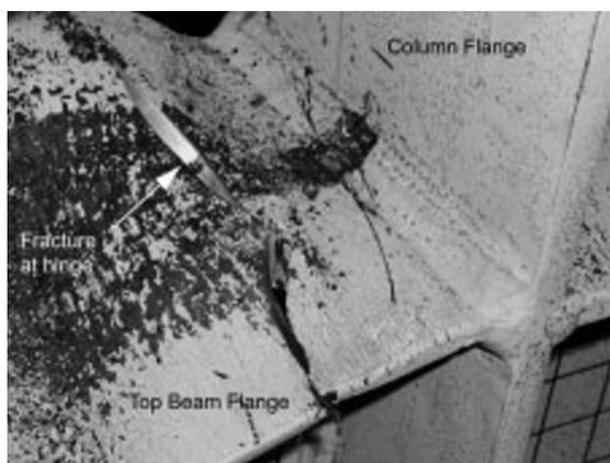
La imagen previa ilustra la fractura en el ala de la viga, junto con un notorio desprendimiento de la capa de pintura en el centro del ala. Asimismo, en el modelo virtual, si bien las tensiones y deformaciones también se distribuyeron en la región de ruptura de una manera similar, desde la parte interna inferior del ala y en la región superior o externa. Las tensiones en el espécimen virtual no concordaron de una forma perfecta con las áreas dañadas o
