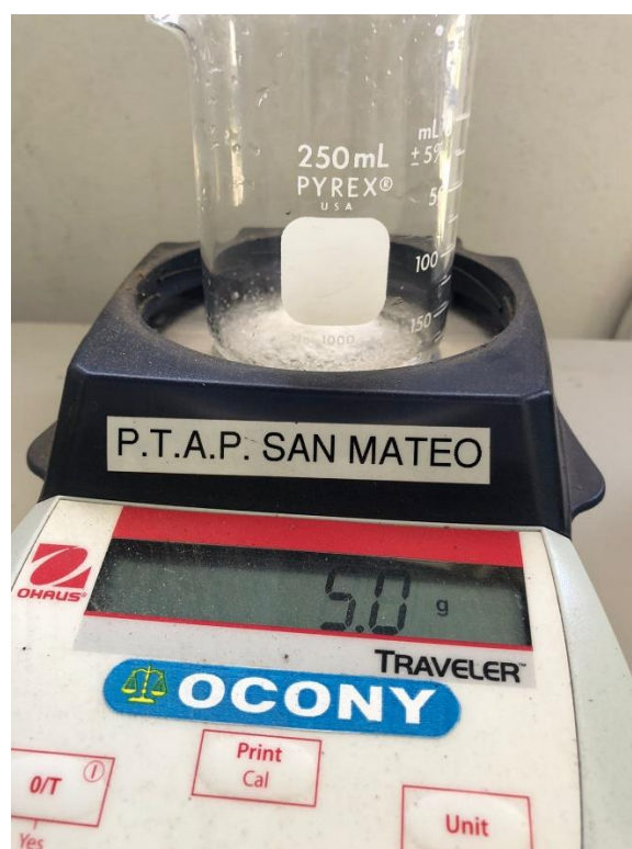
Figura 23 - Trazador químico soluble a utilizar en la prueba de trazadores
