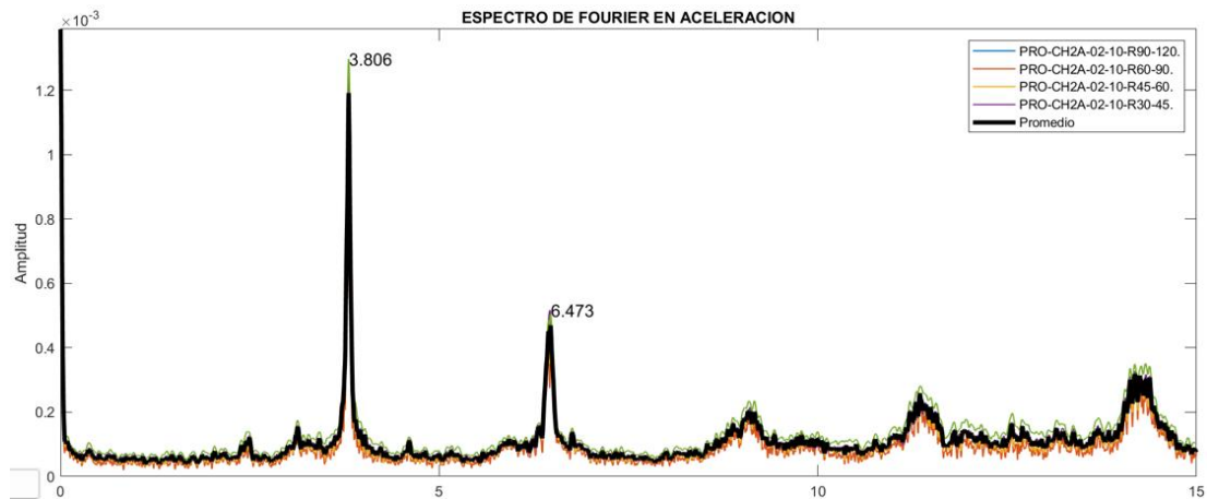
Figura 24. Registro de frecuencias en CH2 A, 02:10, el eje Y muestra las frecuencias
