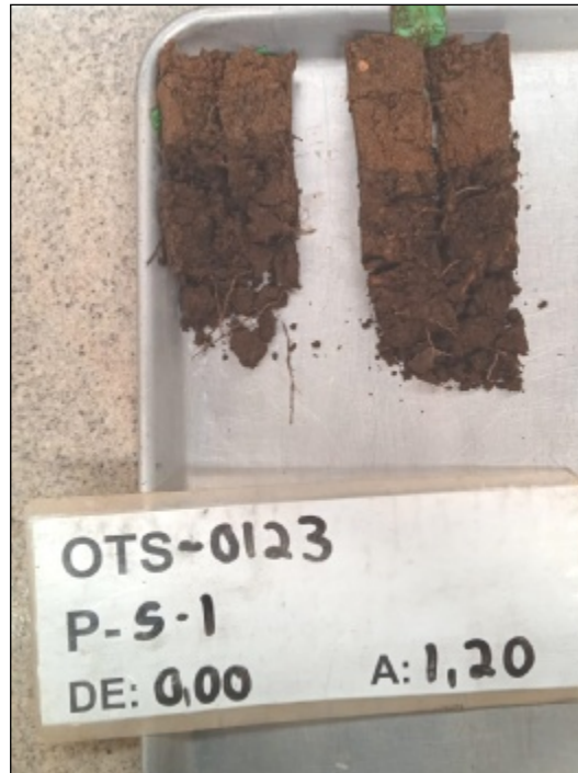
Fotografías. Testigos de perforación. De 0,00 m a 1,20 m.
