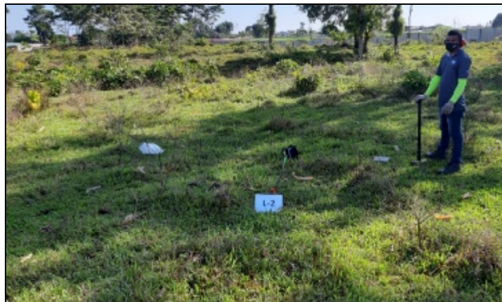
Figura. Vista de la adquisición del tendido sísmico L-2.
