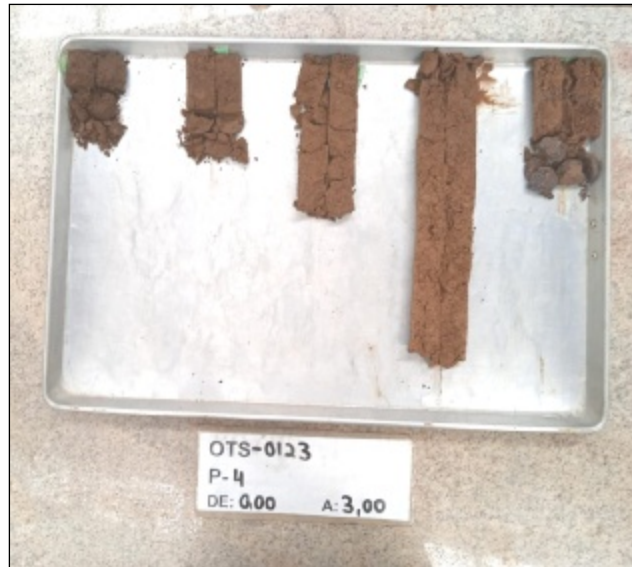
Fotografías. Testigos de perforación. De 0,00 m a 3,00 m.
