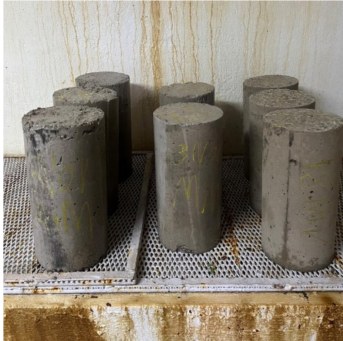
Ilustración 24 Cilindros de concreto finalizados SIN vidrio molido. Fuente Propia
