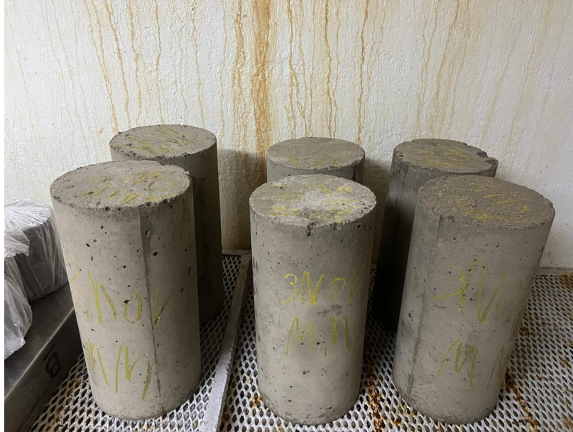
Ilustración 13 Curado final de los especímenes
