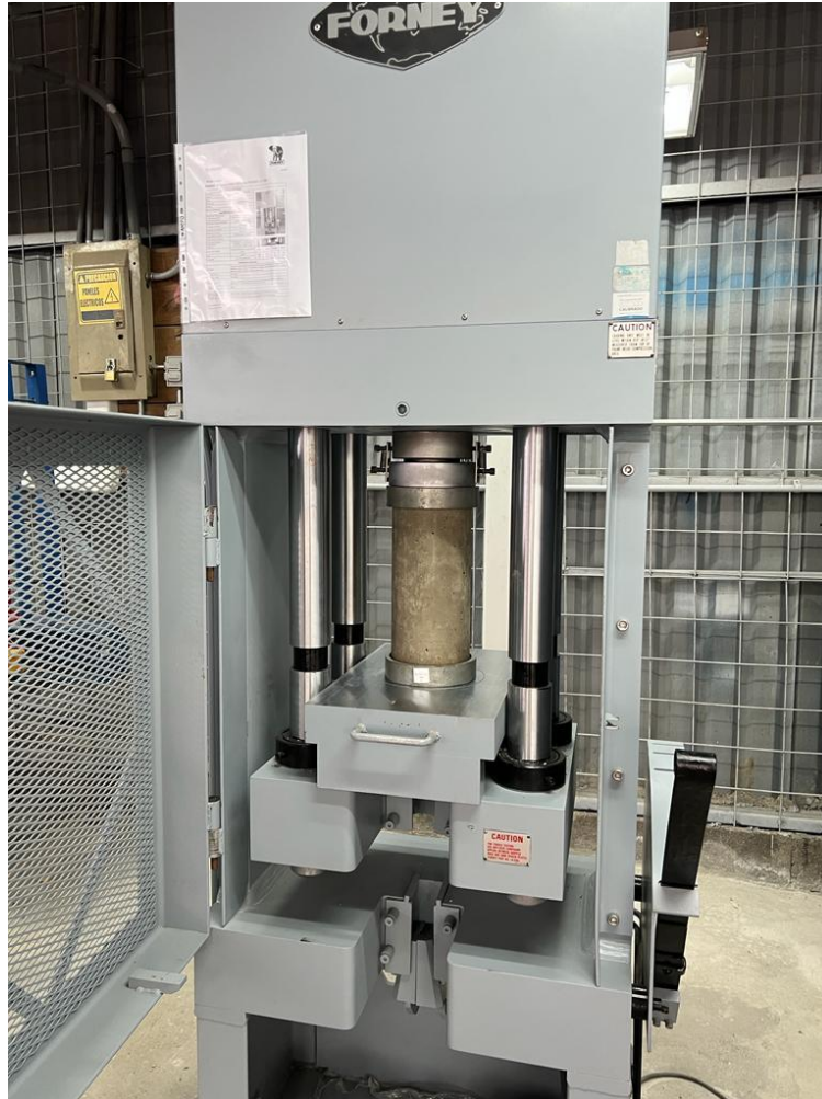
Ilustración 14 Maquina de compresion de cilindros de concreto
