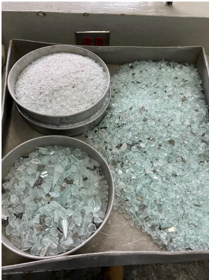
Ilustración 18 Vidrio Molido Separado por Tamaños. Fuente Propia
