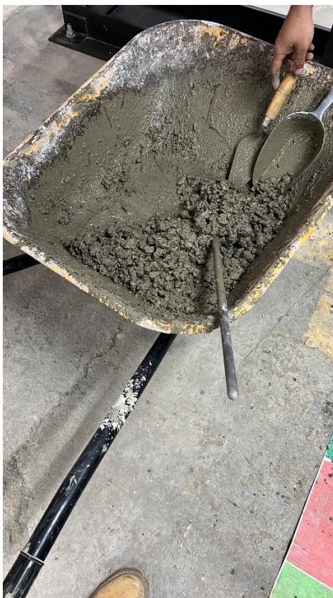
Ilustración 20 Mezcla de concreto sin vidrio molido. Fuente Propia
