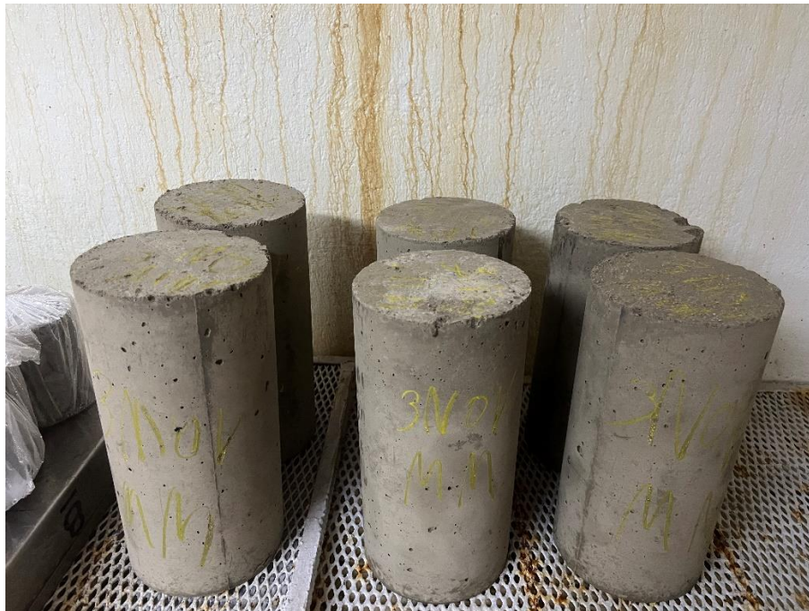
Ilustración 23 Cilindros de concreto finalizados con vidrio molido. Fuente Propia
