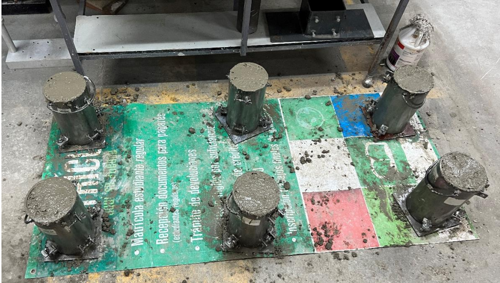
Ilustración 22 Mezcla de concreto en moldes. Fuente propia.
