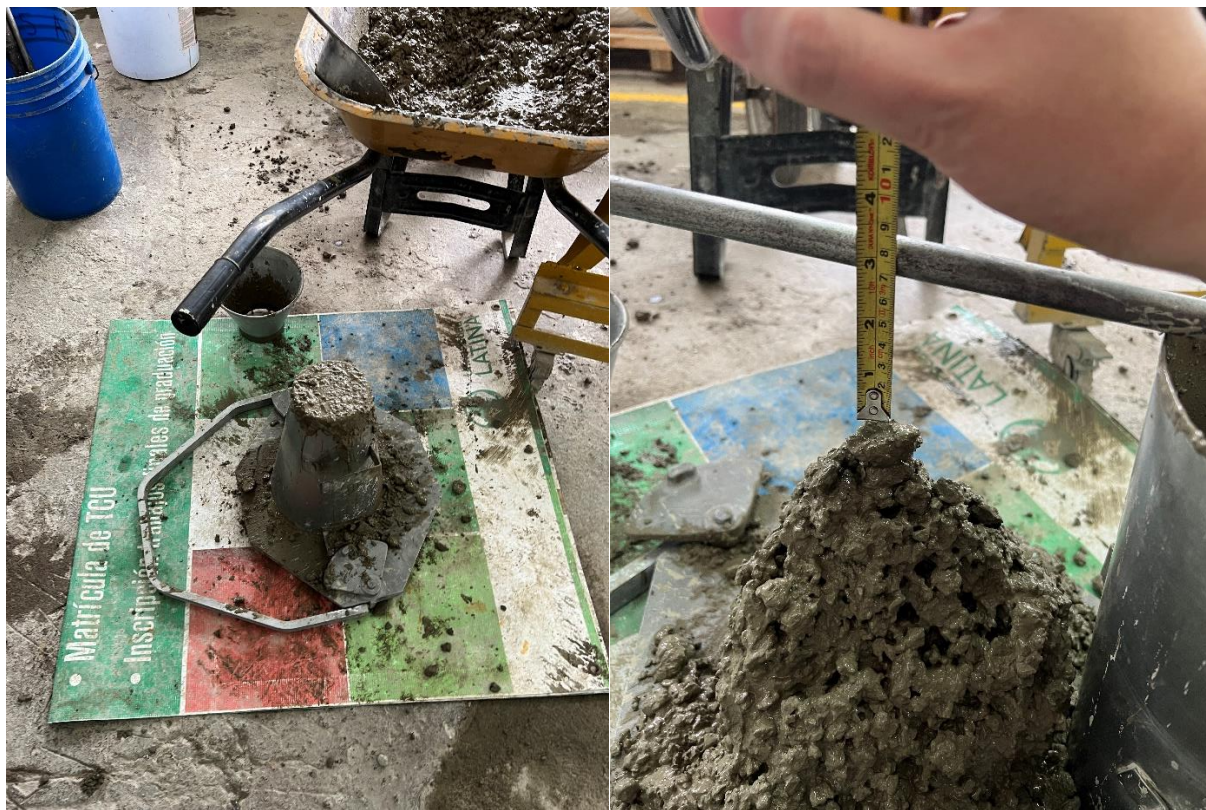
Ilustración 21 Realización y resultado de prueba de cono Abrams. Fuente propia
