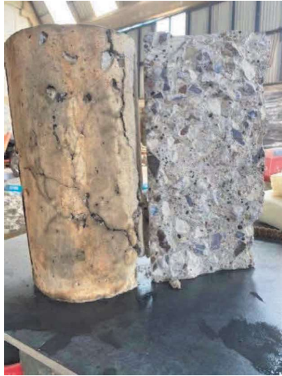
Ilustración 51 Cilindro fallado a tracción falla tipo
