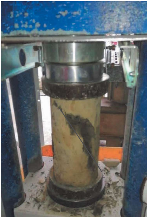
Fuente: Propia (Falla Tipo 4)
