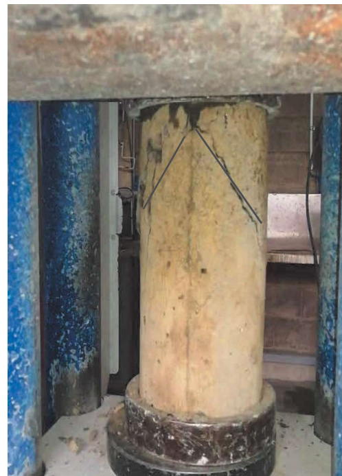
Fuente: Propia (Falla Tipo 6)
