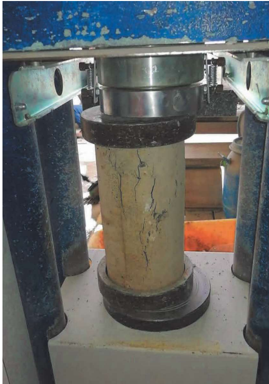
Fuente: Propia (Falla Tipo 3)
