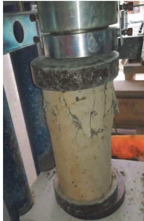
Fuente: Propia (Falla Tipo 2)
