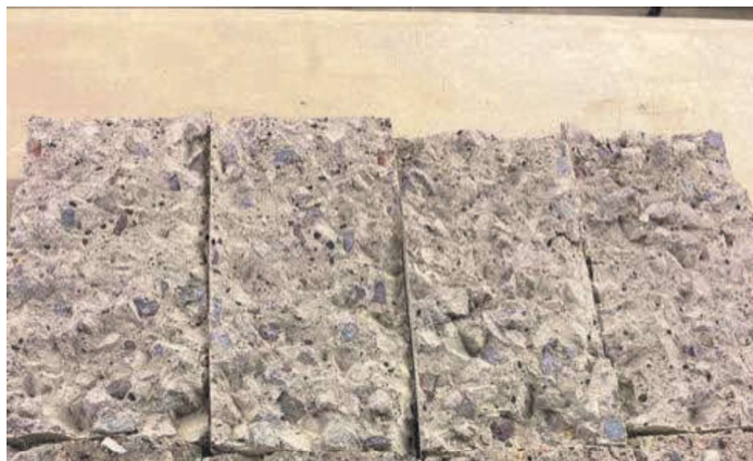
Ilustración 52 Cilindro fallado a tracción falla tipo normal
