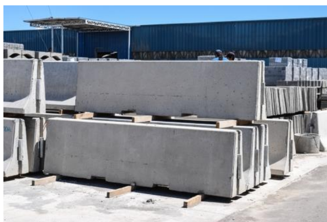
Ilustración 14 Barrera de contención vehicular de tipo New Jersey
