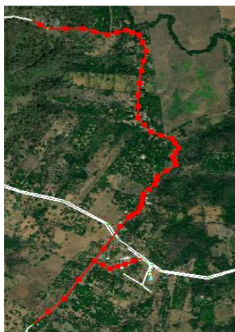
Ilustración 50 Sustitución de diámetros por 75 mm Fuente Propia, 2022
