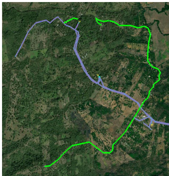
Ilustración 53 Tubería sustituida en el Sector 1 Fuente Propia 2022
