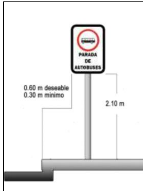
Figura 56 Detalle de colocación de señales verticales
