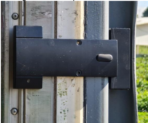
Dispositivo Tetis 3G desarmado parcialmente colocado en contenedor refrigerado con la puerta cerrada para validar el grosor de la abertura.
