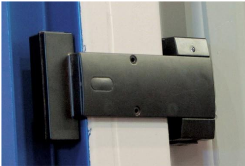
Dispositivo Tetis 3G desarmado parcialmente, colocado en contenedor refrigerado con la puerta abierta.
