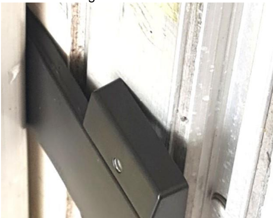
Dispositivo Tetis 3G desarmado parcialmente colocado en contenedor refrigerado con la puerta cerrada para validar el grosor de la abertura.
