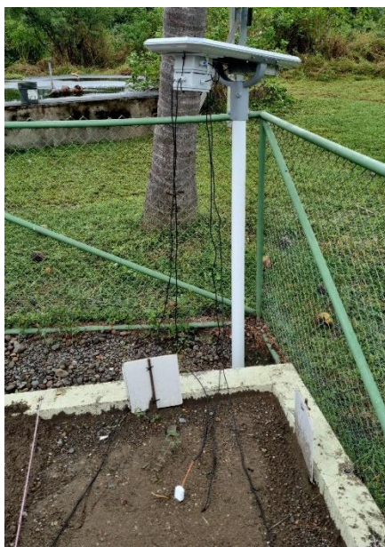
Figura 22: Sistema de Monitoreo de Temperatura y Humedad para Nidos de Tortugas tomando datos de los nidos A1, D3 y F1
