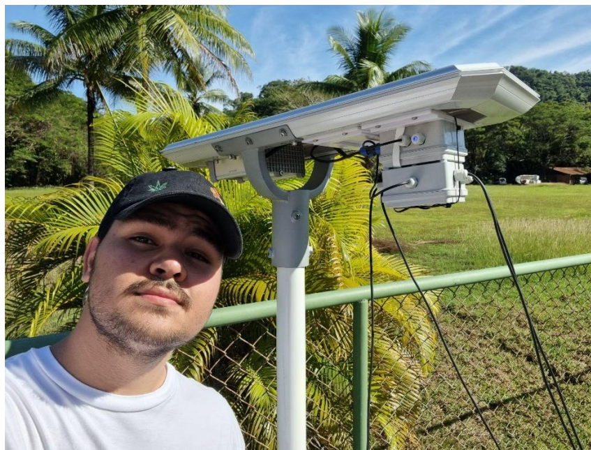
Figura 17: Sistema de Monitoreo de Temperatura y Humedad para Nidos de Tortugas
