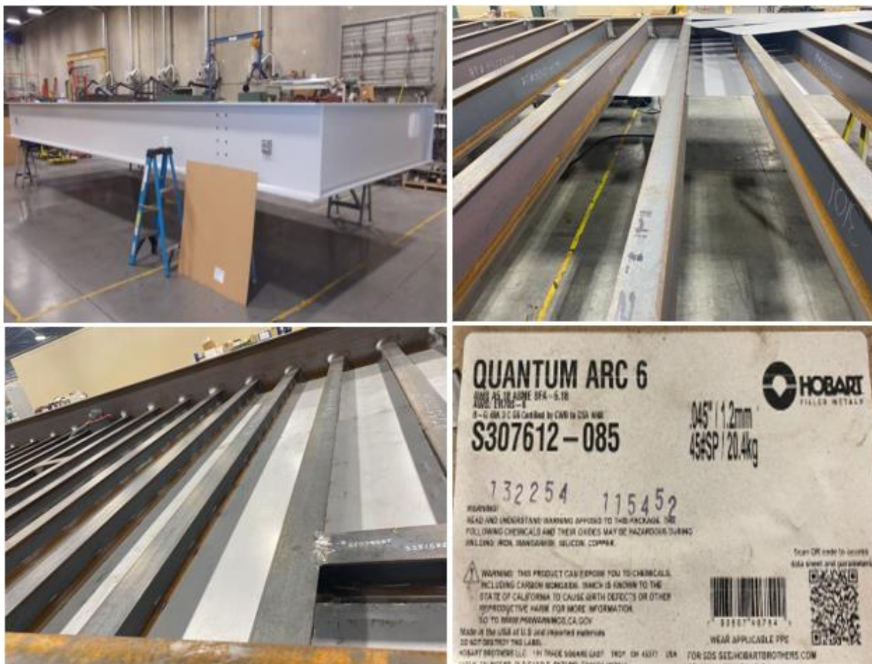
Figura 31: Vigas Estructurales, Lámina Belly Pan y Etiqueta de Soldadura
