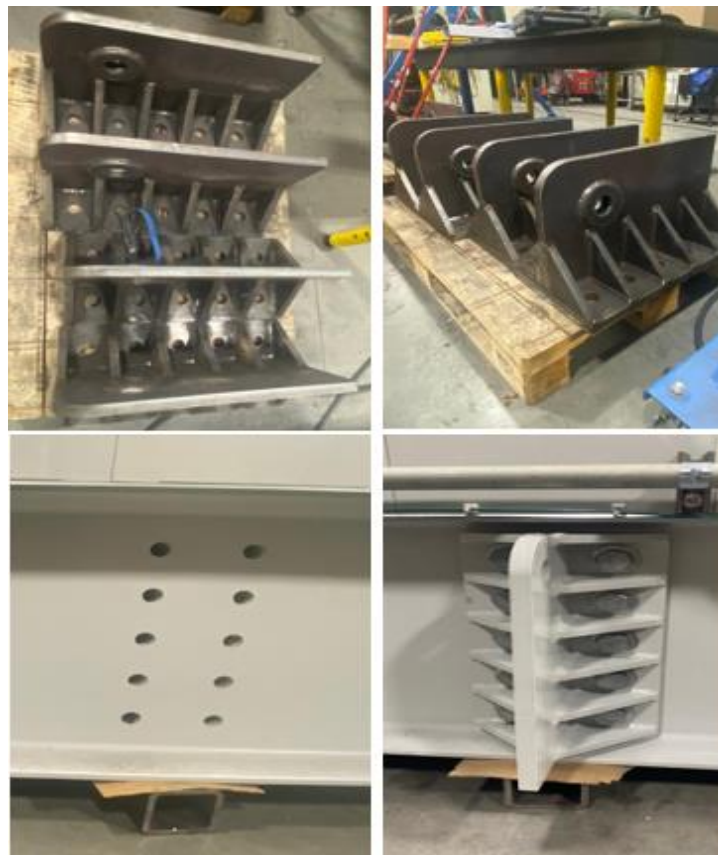
Figura 34: Proceso de Construcción e Instalación de Accesorios de Izaje
