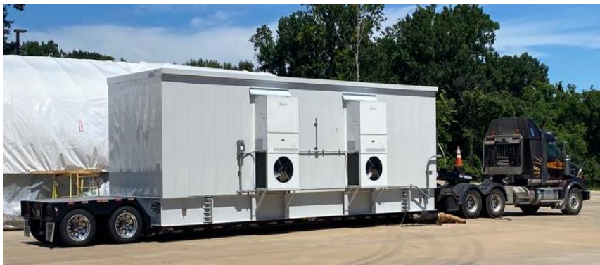
Figura 63: RIE Finalizado y Preparado Para su Transporte a Sitio
