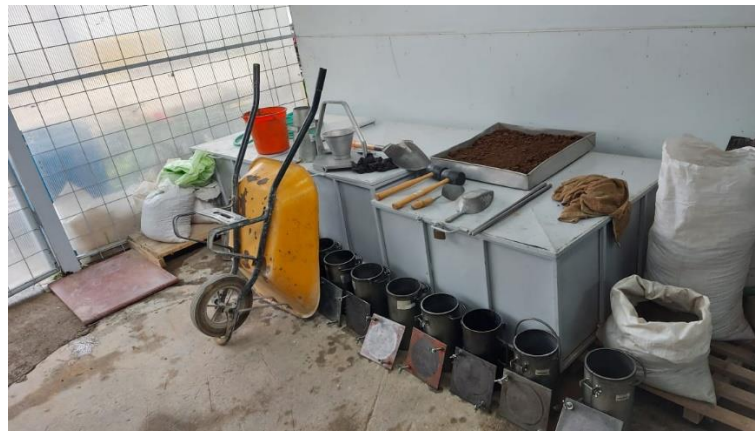
Herramienta utilizada para la elaboración de los especímenes cilíndricos.
