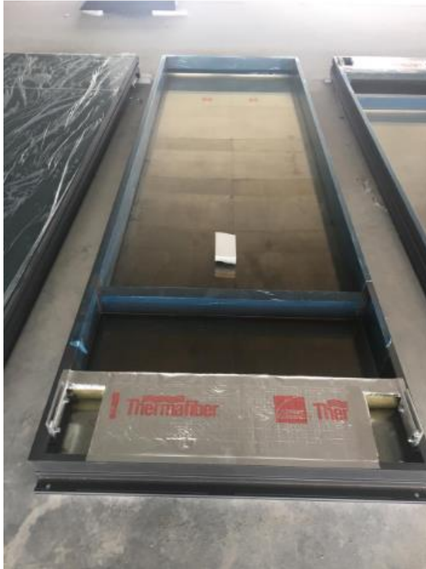
Ilustración 5. Panel lado B armado. Fuente: Propia (2019)
