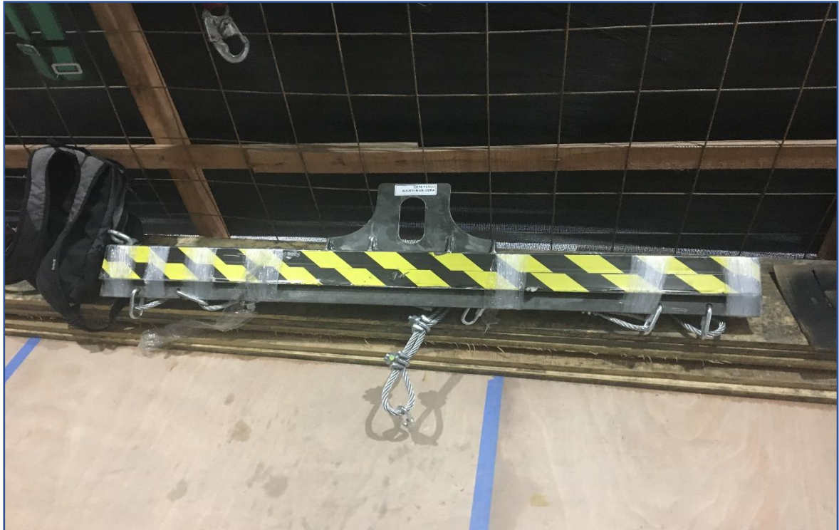
Ilustración 27. Viga de levantamiento, la misma hace la conexión entre grúa y panel.
