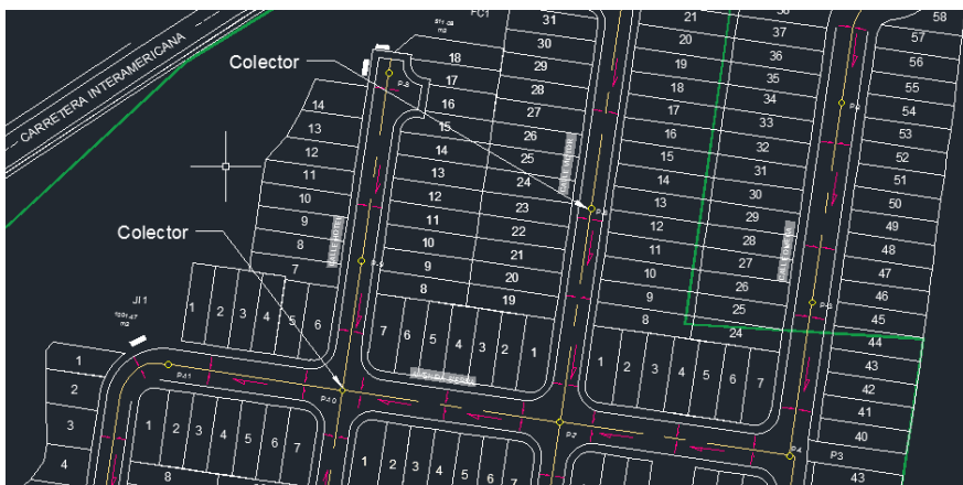
Figura 10. Parte de la distribución de colectores. Fuente: Propia
