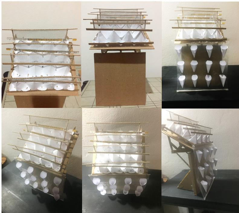
*Nota: Versión 1, primero solo el panel horizontal o sobre cubierta y se añade el panel vertical con una caída simple y ordenamiento de los conos recolectores ordenados también de una manera simple sobre su superficie plana. Fuente: elaboración propia. (2022)*
