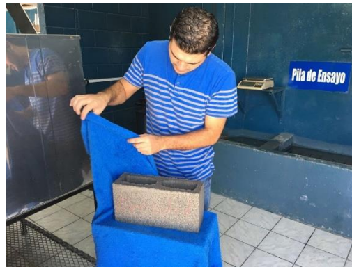
Ilustración 29. Secado del bloque para tomar el peso saturado superficie seca
