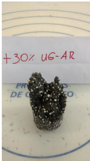
Ilustración 62. Ensayo a la compresión de cilindros con 30% más de cemento UG-AR
