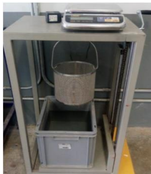
Ilustración 12. Balanza para determinar densidades de sólidos
