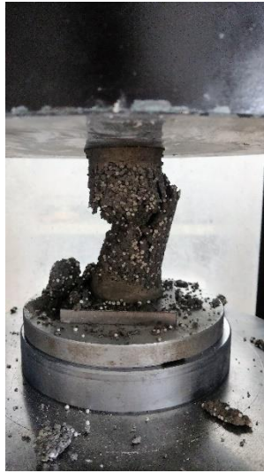
Ilustración 69. Ensayo de resistencia a la compresión mediante prensa hidráulica
