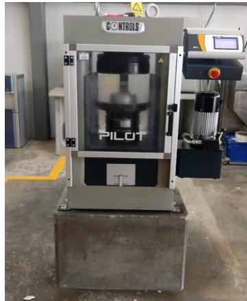
Ilustración 41. Ensayo de resistencia a la compresión en espécimen de 5 cm x 10 cm
