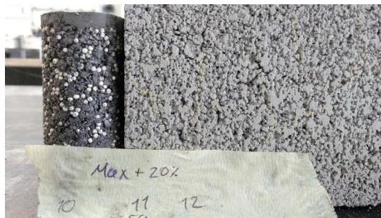
Ilustración 59. Textura superficial del cilindro con EPS vs. bloque
