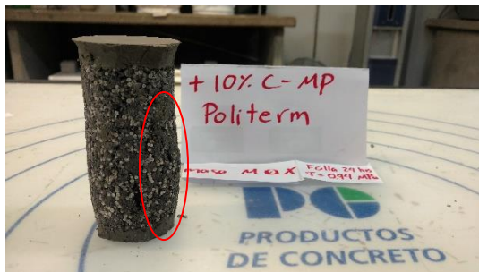
Ilustración 71. Ensayo de resistencia a la compresión de cilindro con Politerm
