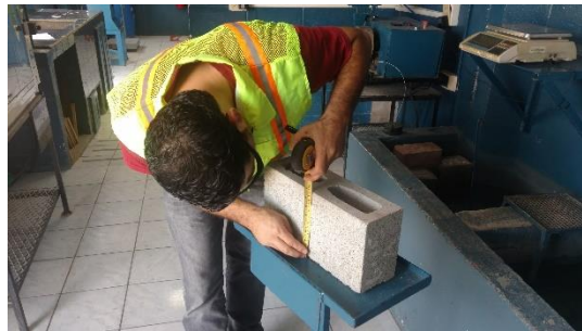
Ilustración 23. Dimensiones de la altura del bloque
