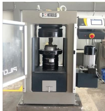
Ilustración 42. Ensayo a compresión del espécimen de 5 cm x 10 cm mediante presa hidráulica
