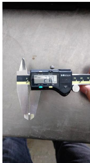
Ilustración 51. Medición del diámetro de las esferas de EPS
