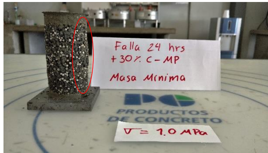
Ilustración 58. Ensayo a 24 horas en cilindro de masa mínima
