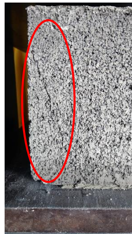
Ilustración 34. Ensayo a la compresión del bloque a 7 días
