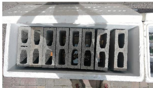
Ilustración 19. Método de curado propuesto
