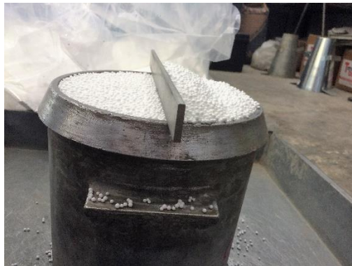
Ilustración 53. Muestra de EPS para cálculo de densidad aparente
