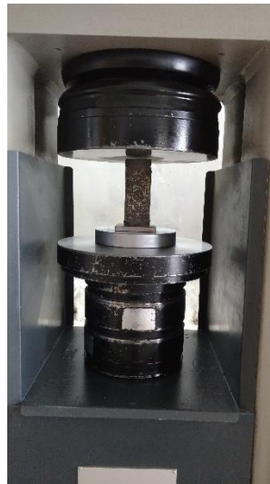
Ilustración 56. Ensayo de resistencia a la compresión mediante prensa hidráulica
