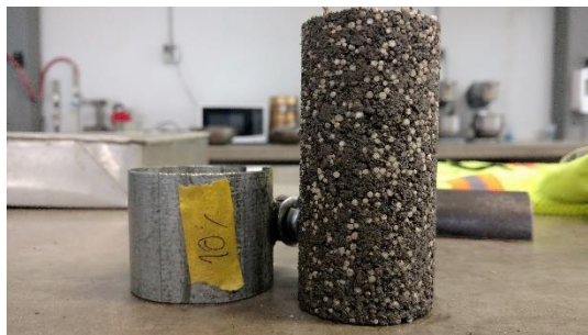
Ilustración 68. Cilindro con Politerm + aditivo acelerante de resistencia
