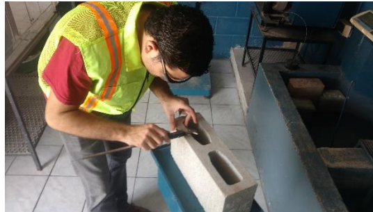
Ilustración 25. Dimensiones del espesor de las paredes externas del bloque
