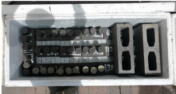
Ilustración 36. Curado de cilindros en caja de poliestireno con lámina de agua
