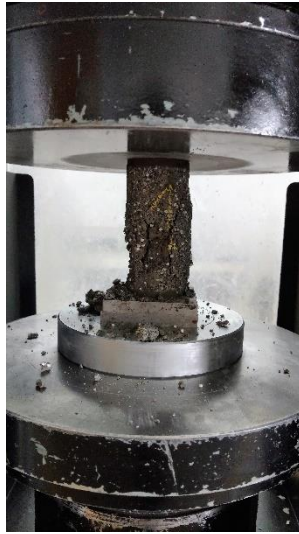
Ilustración 61. Ensayo a compresión de cilindro con EPS y cemento UG-AR
