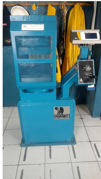
Ilustración 21. Prensa hidráulica para ensayar bloques a compresión
