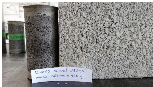
Ilustración 47. Evaluación de textura superficial, cilindro masa máxima vs. bloque de 12 cm x 20 cm x 40 cm
