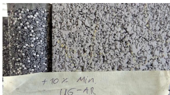
Ilustración 65. Textura superficial de cilindro con cemento UG-AR vs. bloque
