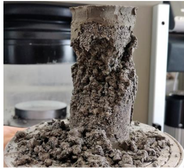
Ilustración 43. Ensayo a compresión del espécimen de 5 cm x 10 cm
