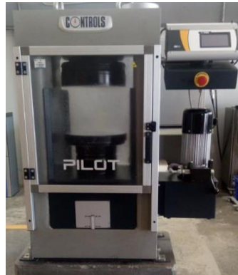
Ilustración 14. Prensa hidráulica automática de ensayo a compresión
