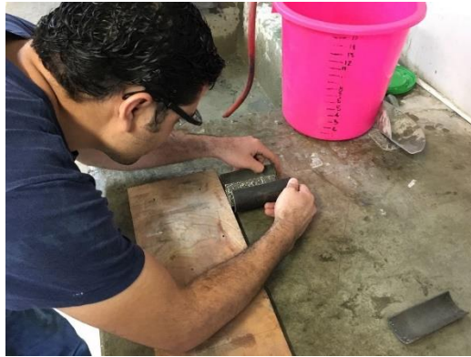
Ilustración 79. Ensayo de cohesión a cilindros con EPS
