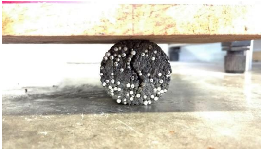
Ilustración 82. Falla por ensayo de cohesión a cilindros con EPS
