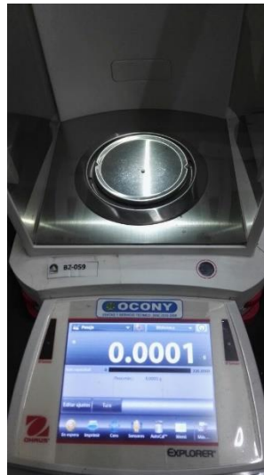
Ilustración 50. Peso de las esferas de EPS en balanza analítica
