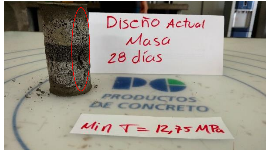
Ilustración 46. Ensayo a 28 días cilindro de masa mínima hecho con mezcla tomada directamente de la planta
