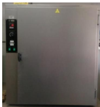
Ilustración 13. Horno ventilado capaz de mantener una temperatura de 110\text{ }^{\circ}\text{C} \pm 5\text{ }^{\circ}\text{C}
