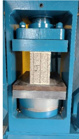
Ilustración 33. Prensa hidráulica para ensayo a esfuerzos de compresión en bloque
