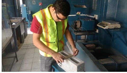
Ilustración 24. Dimensiones del ancho del bloque
