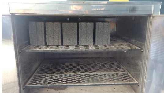
Ilustración 31. Secado al horno de los bloques
