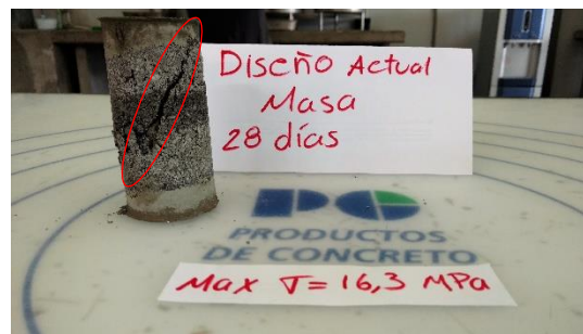
Ilustración 44. Ensayo a 28 días cilindro de masa máxima hecho con mezcla tomada directamente de la planta
