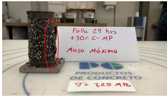
Ilustración 76. Ensayo a la compresión en cilindros con EPS a 24 horas
