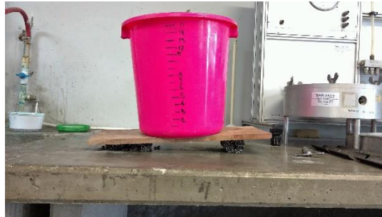
Ilustración 83. Falla por ensayo de cohesión a cilindros con EPS
