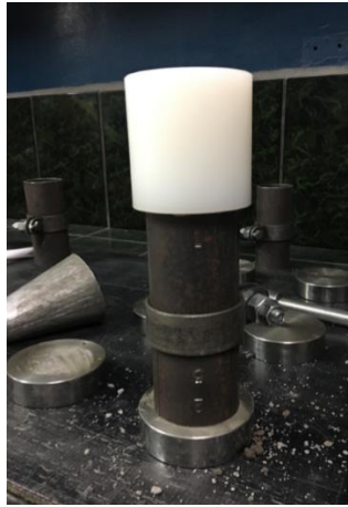
Ilustración 35. Especimen con masa máxima, compactación óptima
