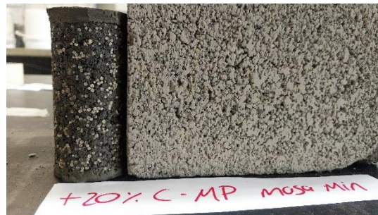
Ilustración 73. Textura superficial en cilindro con Politerm vs. bloque
