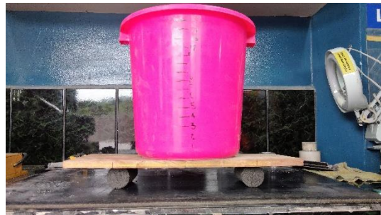
Ilustración 37. Prueba de cohesión en los cilindros
