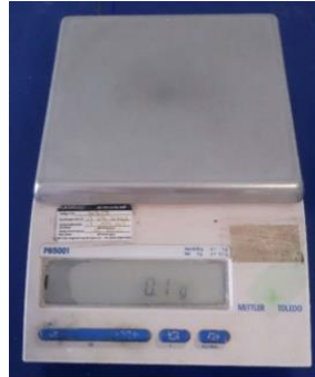
Ilustración 11. Balanza de precisión de 0.1% de la masa de ensayo
