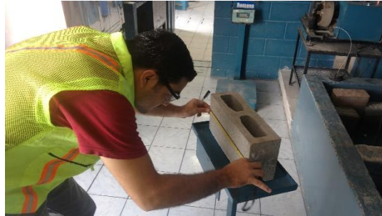
Ilustración 22. Dimensiones de la longitud del bloque
