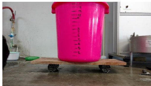
Ilustración 81. Ensayo de cohesión a cilindros con EPS
