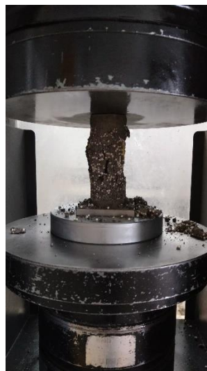
Ilustración 57. Ensayo a compresión del espécimen de 5 cm x 10 cm con EPS
