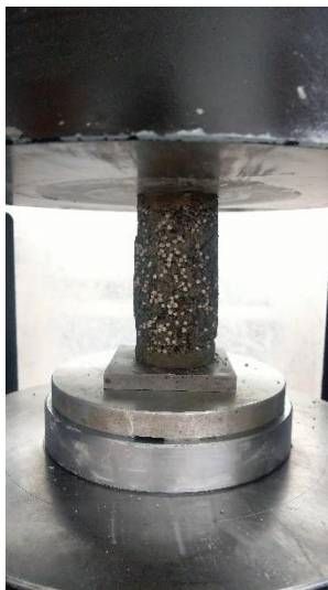
Ilustración 75. Ensayo a la compresión del espécimen en prensa hidráulica
