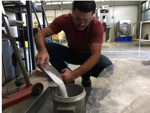
Ilustración 52. Toma de muestra de EPS para densidad aparente
