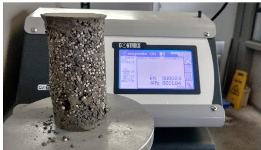
Ilustración 70. Ensayo de resistencia a la compresión en cilindro con Politerm
