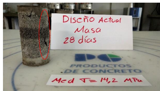
Ilustración 45. Ensayo a 28 días cilindro de masa media hecho con mezcla tomada directamente de la planta
