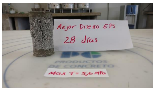
Ilustración 78. Ensayo a la compresión en cilindro con EPS a los 28 días
