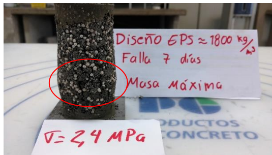
Ilustración 77. Ensayo a la compresión en cilindro con EPS a los 7 días
