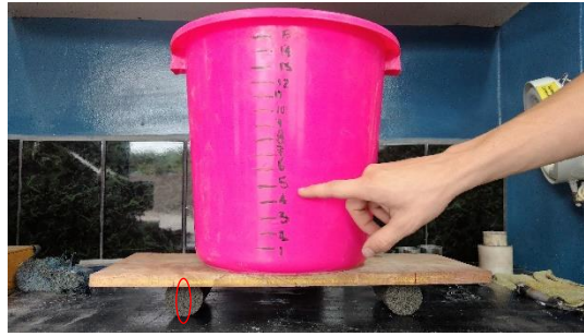
Ilustración 38. Fisura del espécimen a los 5 kg
