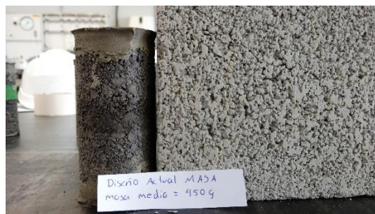
Ilustración 48. Evaluación de textura superficial, cilindro masa media vs. bloque de 12 cm x 20 cm x 40 cm
