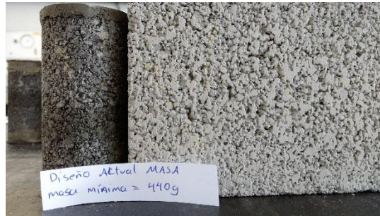
Ilustración 49. Evaluación de textura superficial, cilindro masa mínima vs. bloque de 12 cm x 20 cm x 40 cm
