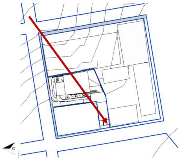
Figura 70. Dirección de escorrentía y desnivel de terreno
