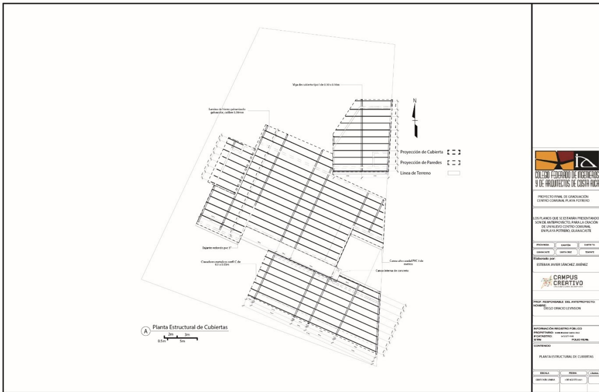
Figura 59 Planta estructural cubiertas
