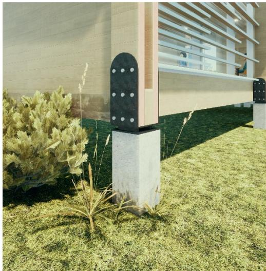
*Nota 25. Sistema de cimientos con placas de acero y columnas de manera conteniendo el marco estructural de vigas.
