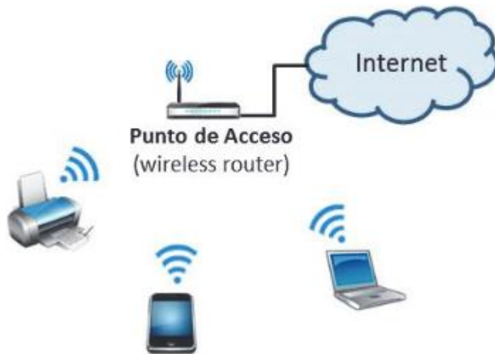
Figura 4. Esquema de WLAN en un hogar
