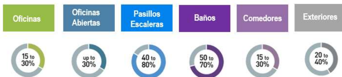
Figura 29: Ahorro de energía con la colocación de sensores de presencia.
