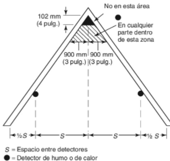
**Ilustración 12. Ubicación de los detectores en el cielo raso de 2 aguas**
