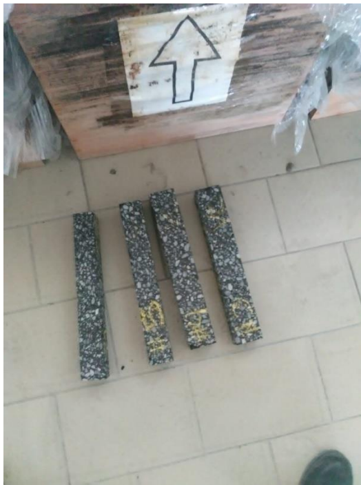
Figura 23. Vigas para ensayo de fatiga.
