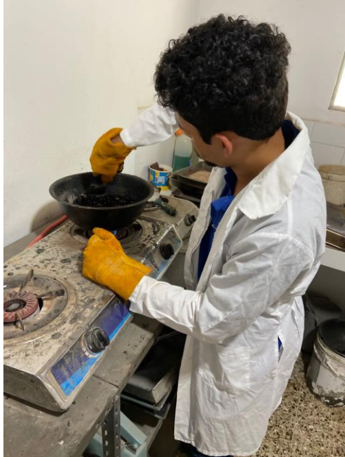
Figura 17. Proceso de cocinado de mezcla asfáltica
