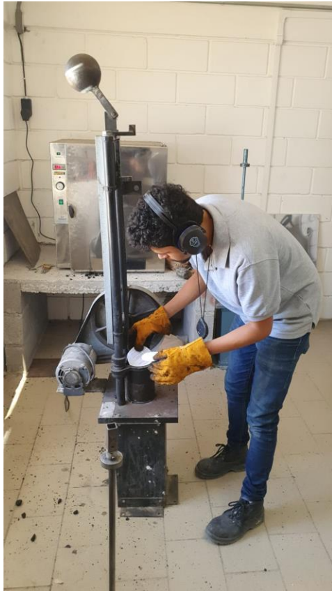
Figura 19. Proceso de compactación Marshall.
