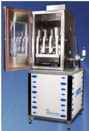
Figura 15. Equipo para pruebas de fatiga por flexión con viga independiente bff-5
