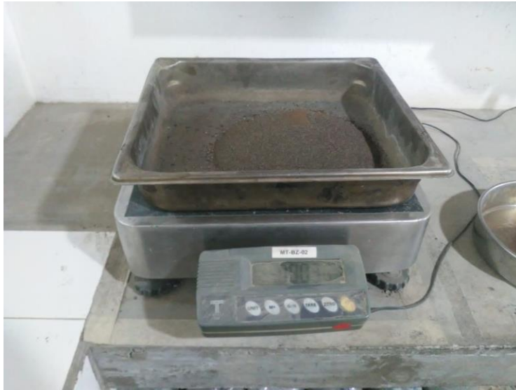
Figura 22. Proceso de pesado en granulometría.
