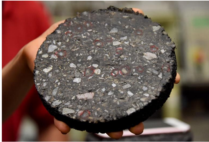
Figura 1: Muestra de pastilla de mezcla asfáltica modificada
