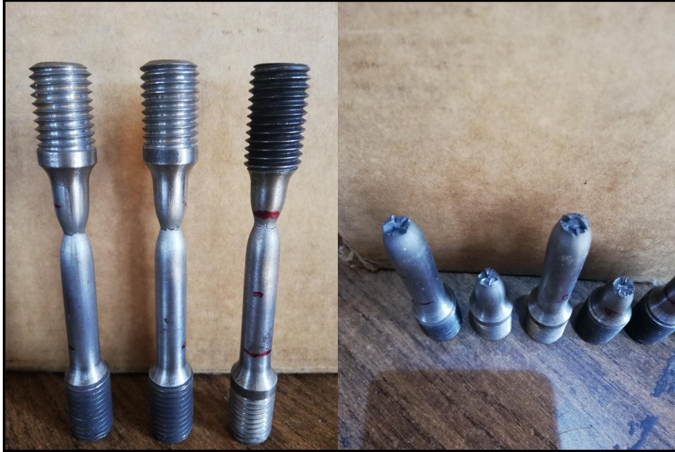
Ilustración 59. Fotografía de probetas de pernos ASTM A325 falladas por ensayo a tensión ASTM E8M
