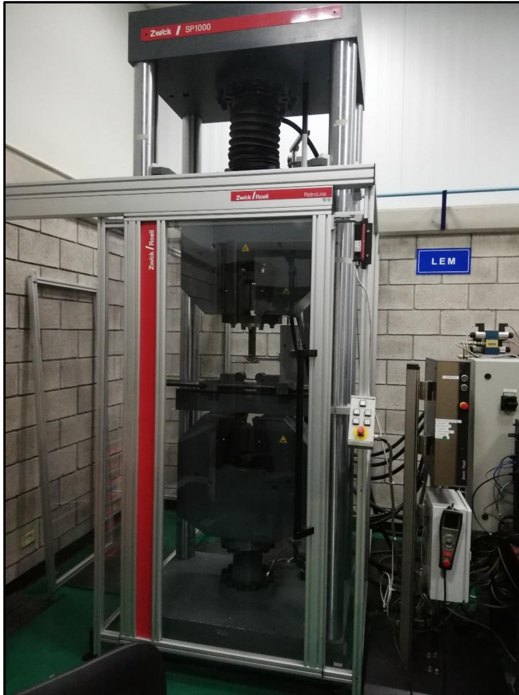
Ilustración 29. Máquina Universal de Ensayos de 1 Mega Newton para ensayos de Acero A36
