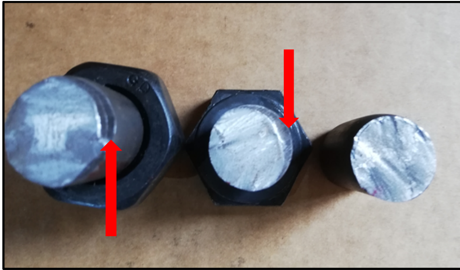
Ilustración 78. Fotografía de la cara del plano de ruptura por cortante del perno ASTM A325
