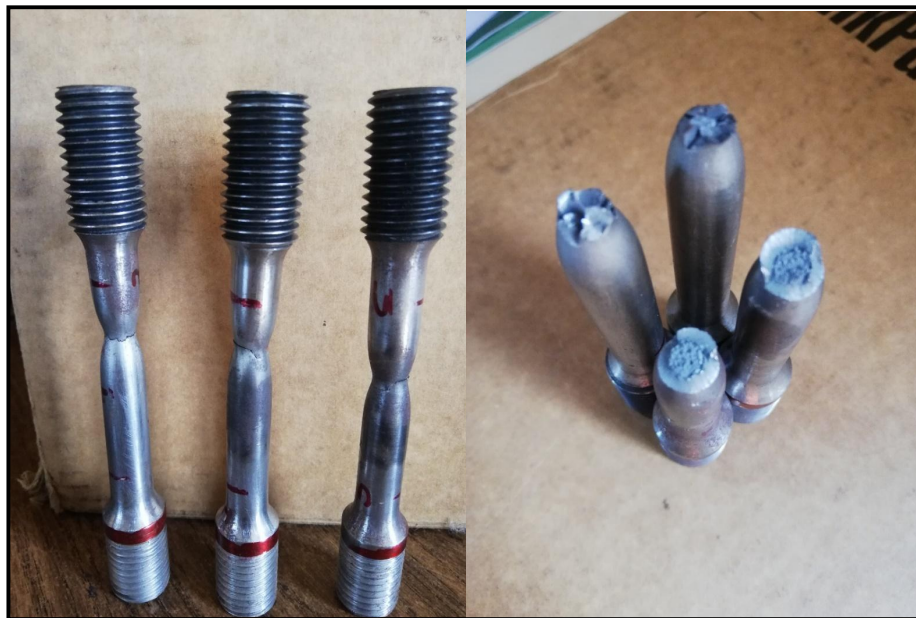
Ilustración 56. Fotografía de probetas de pernos SAE J429 grado 5, falladas por ensayo a tensión ASTM E8M
