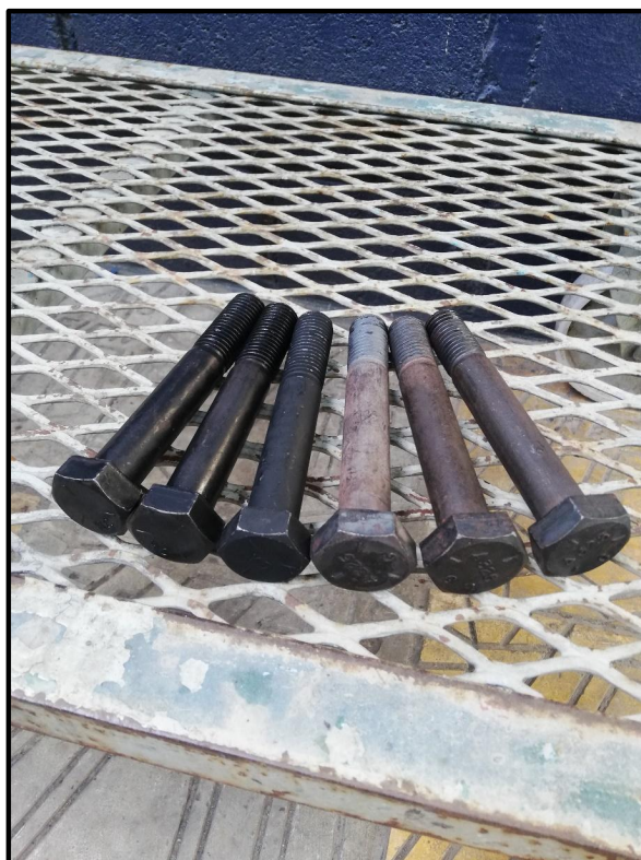
Ilustración 23. Pernos grado 5 y A325 para la fabricación de probetas
