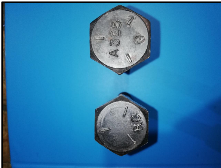
Ilustración 22. Identificación de pernos grado 5 y A325
