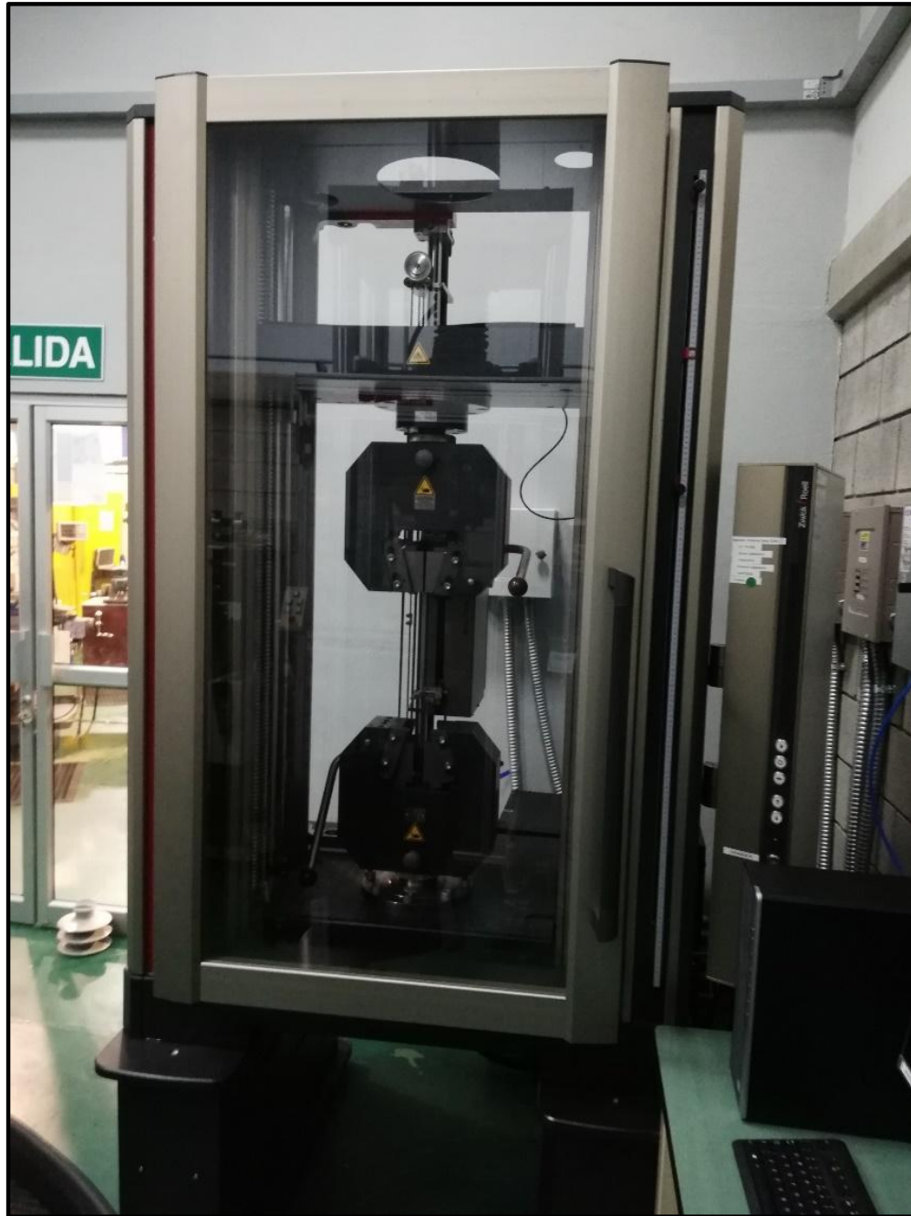
Ilustración 28. Máquina Universal de Ensayos de 250 Newton para ensayos de pernos
