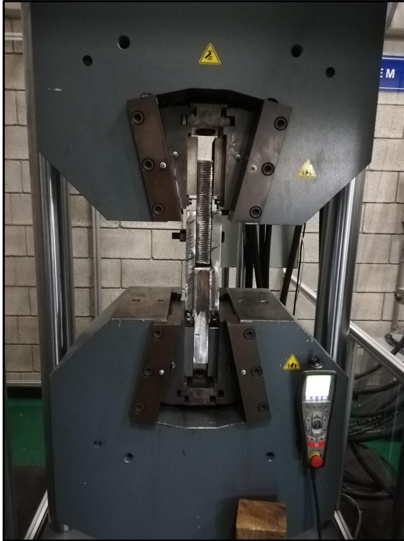
Ilustración 48. Ensayo a cortante personalizado
