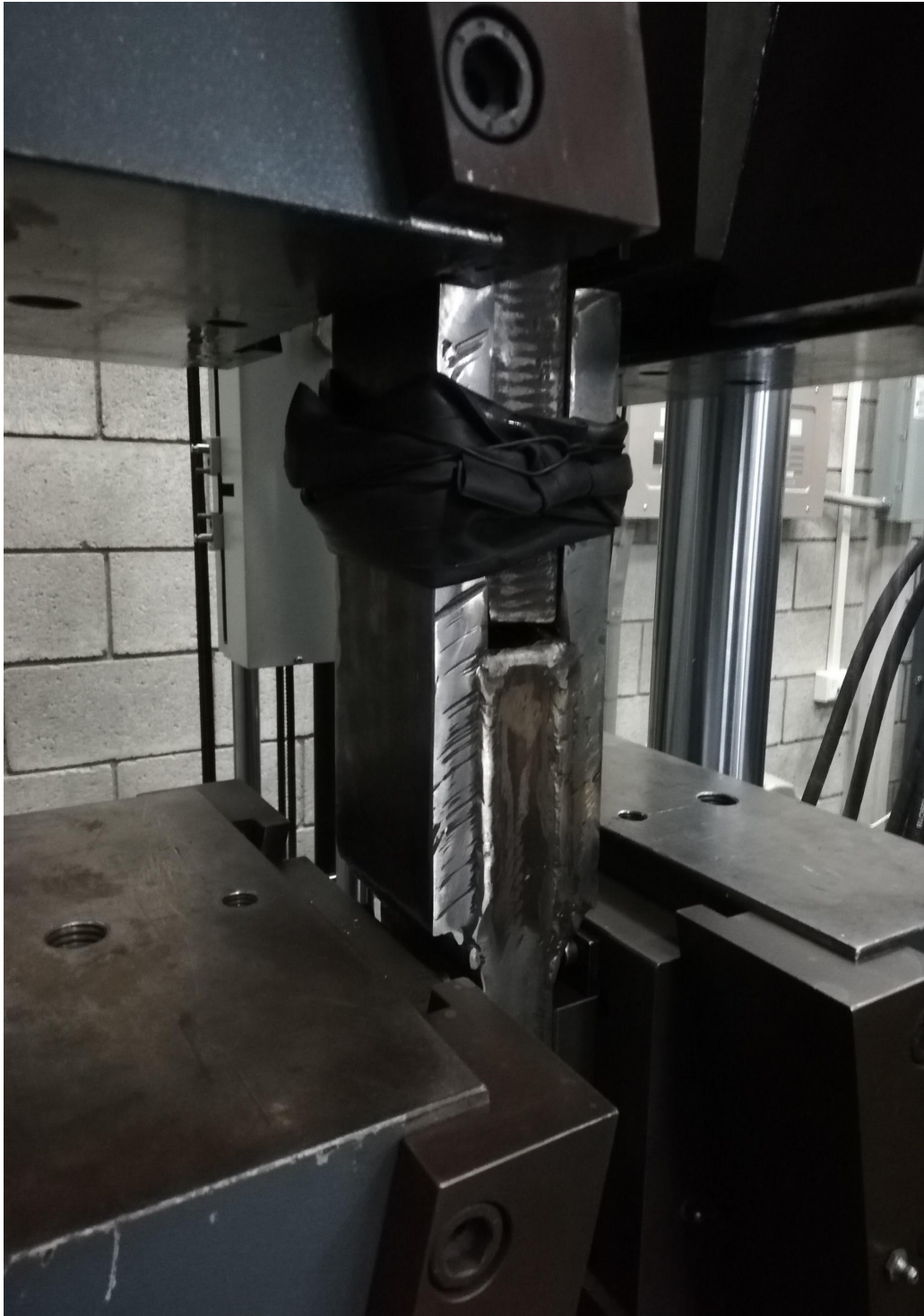
Conexión ya colocada en la maquina universal de ensayos con un material alrededor elastómero para protección de los participantes del ensayo
