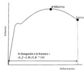
Figura 2. Esquema de ubicación de las variables de medición. (Alcance de Ensayo P GR 12, LEM 119)
