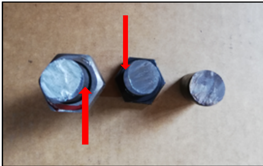
Ilustración 76. Fotografía de la cara del plano de ruptura por cortante del perno SAE J429 grado 5
