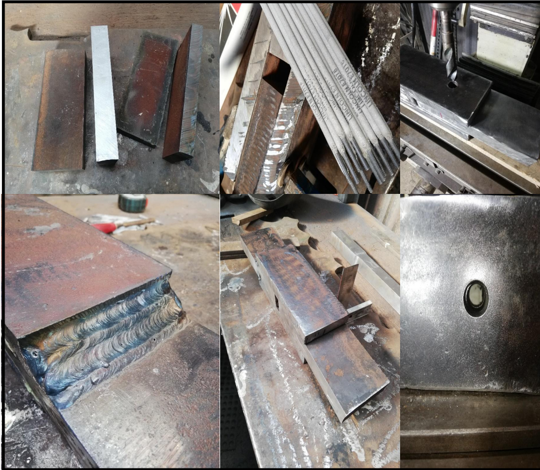
Ilustración 46. Proceso de fabricación conexión a doble cortante
