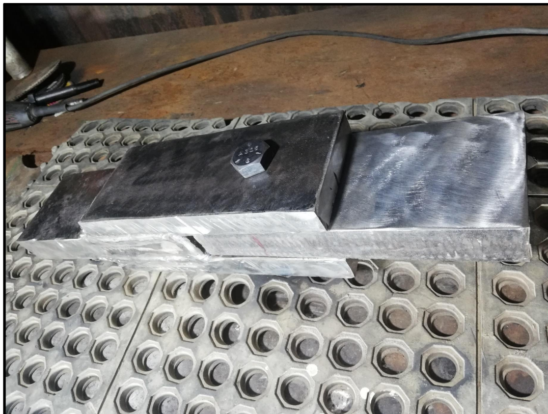
Ilustración 47. Conexión a doble cortante A36 final
