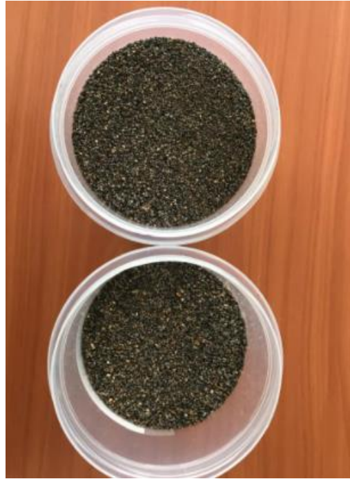
Figura. 23. Arena sílice para filtros.
