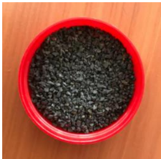
Figura. 25. Antracita para purificación del agua.
