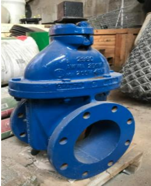
Figura. 37. Vista lateral de la válvula de compuerta.
