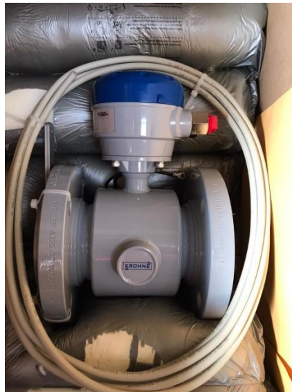
Figura. 11. Sensor de flujo (Macromedidor).
