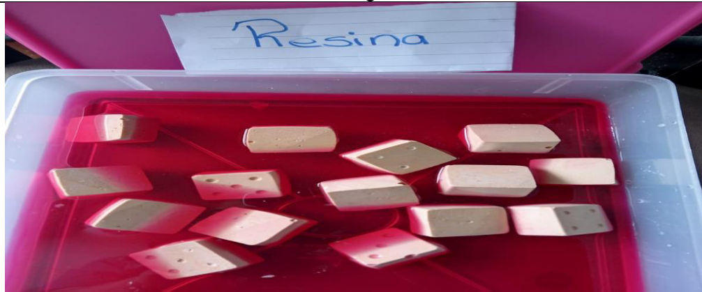
Premolares obturados con Cention-N con adhesivo sumergidos en Fucsina.
