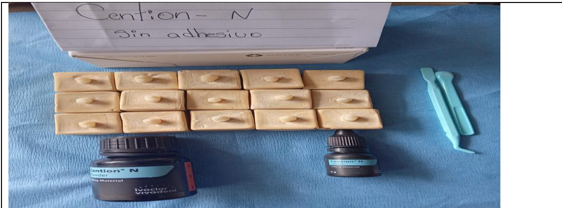
Piezas obturadas con Resina sumergidas en Fucsina
