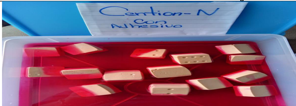
Premolares obturados con Cention-N sin adhesivo sumergidos en Fucsina.
