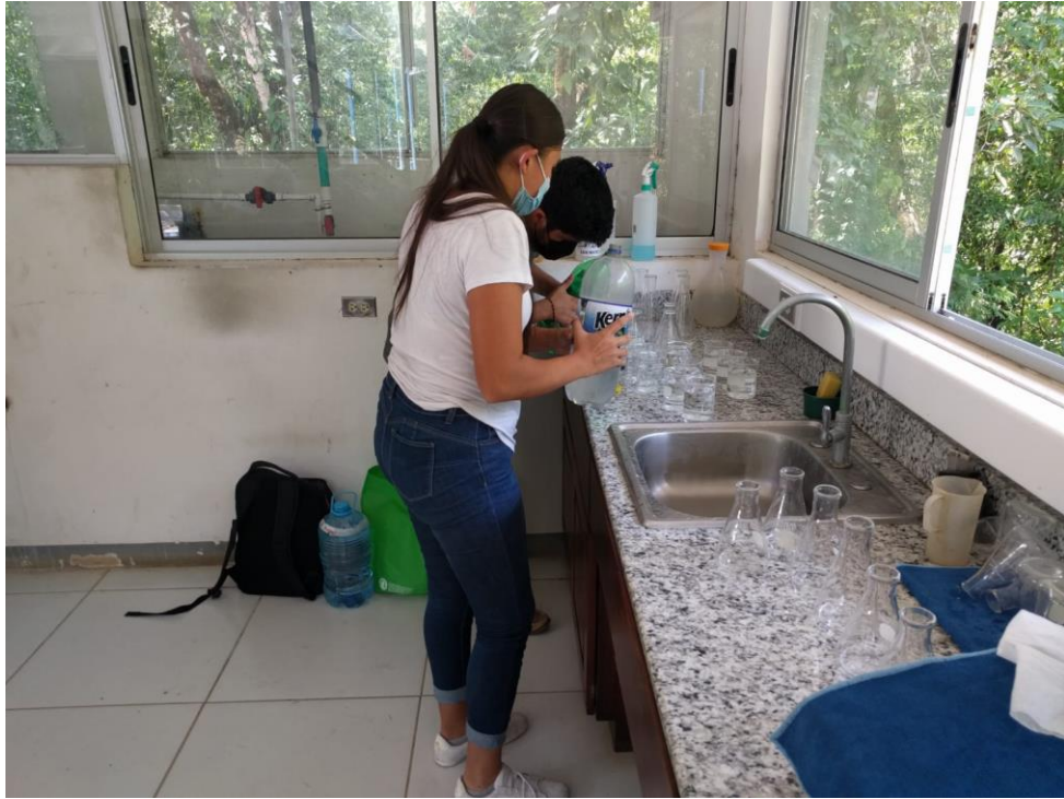
Ilustración 30. Ensayo de dosis optima de cloro
