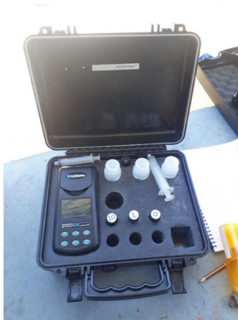
Figura 25 Turbidímetro, instrumento utilizado para medir turbiedades en el agua
