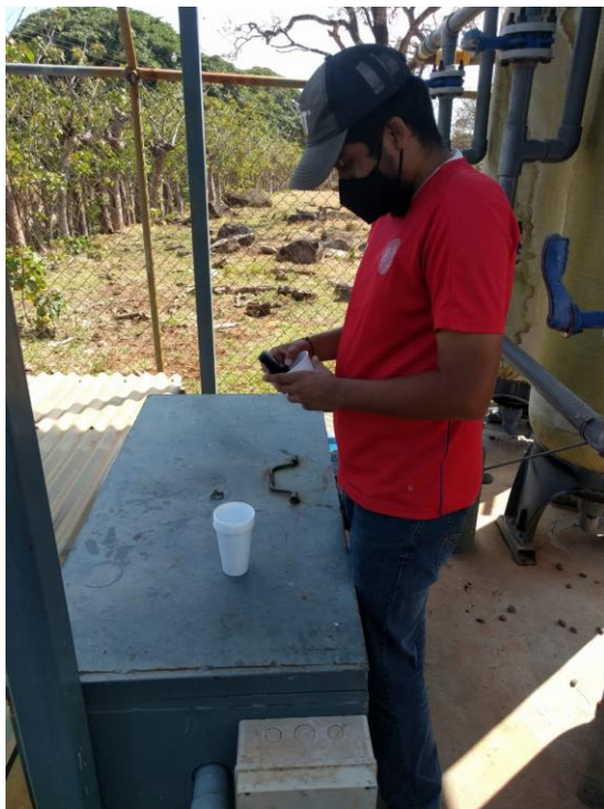
Figura 29 Medición de conductividad de la prueba de trazadores realiza en la planta potabilizadora
