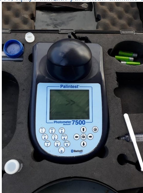
Figura 24: Photometer 7500, equipo utilizado para medir aluminio en la planta potabilizadora
