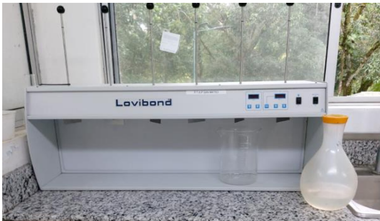
Figura #13. Equipo para la prueba de Jarras.
