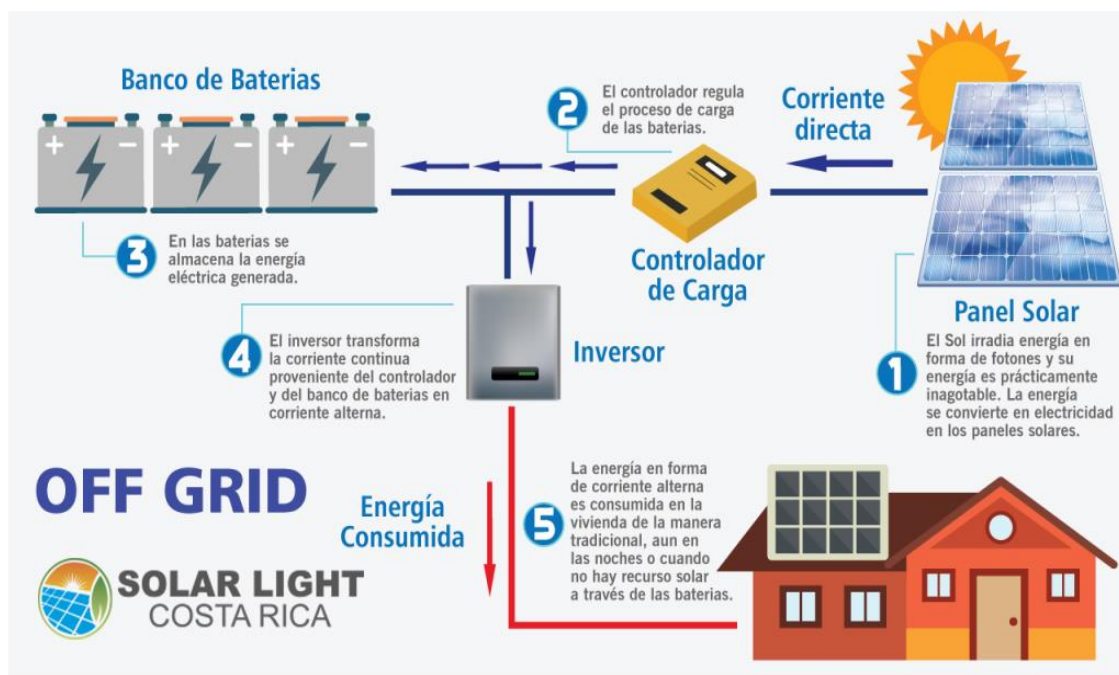
Figura No.7: Esquema no interconectado a la red
